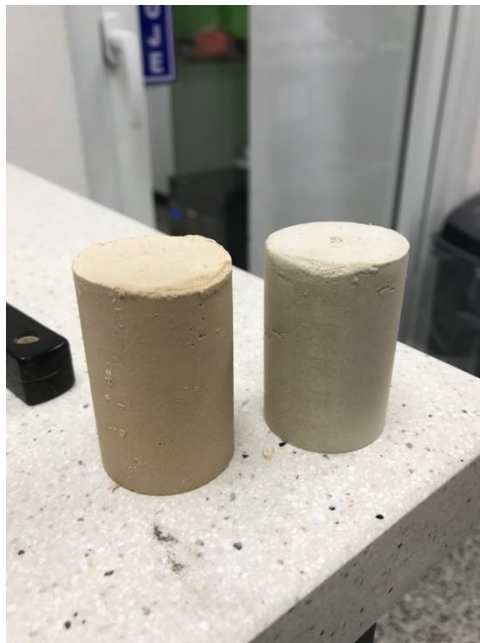
Figura 19. Otras mezclas de arcilla solidificadas, listas para cortar
