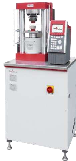
Figura 8. Resistencia a la compresión ToniZEM
