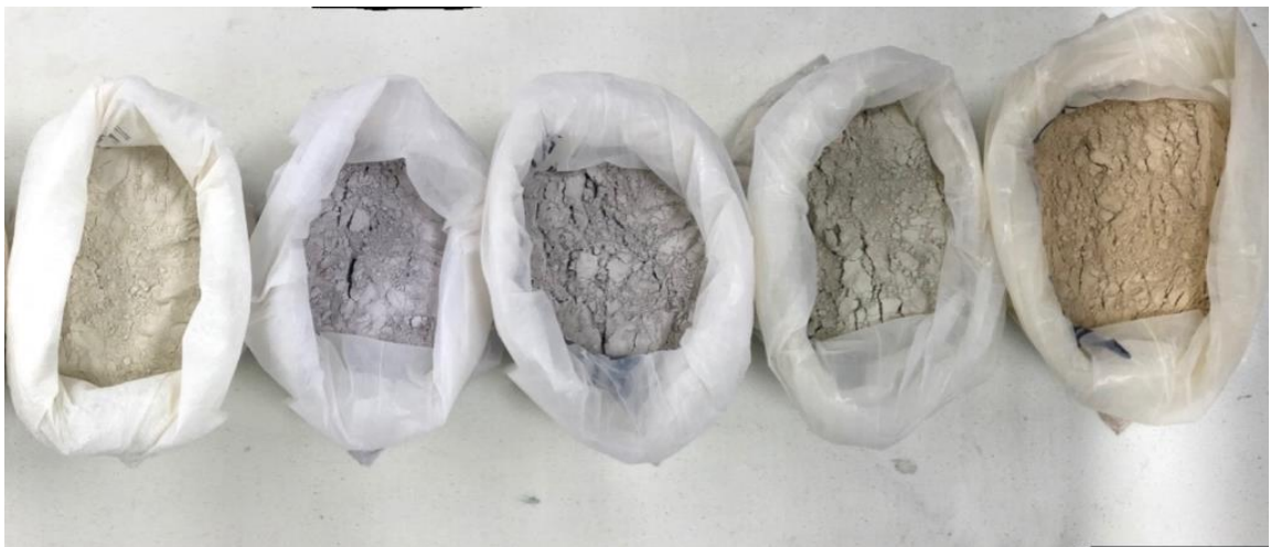
Figura 14. Arcillas evaluadas por medio de la técnica de agua combinada
