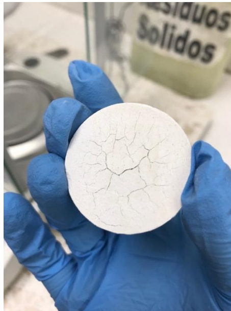
Figura 25. Apariencia de la pastilla luego de pasar por el proceso de calentamiento para la técnica de agua combinada
