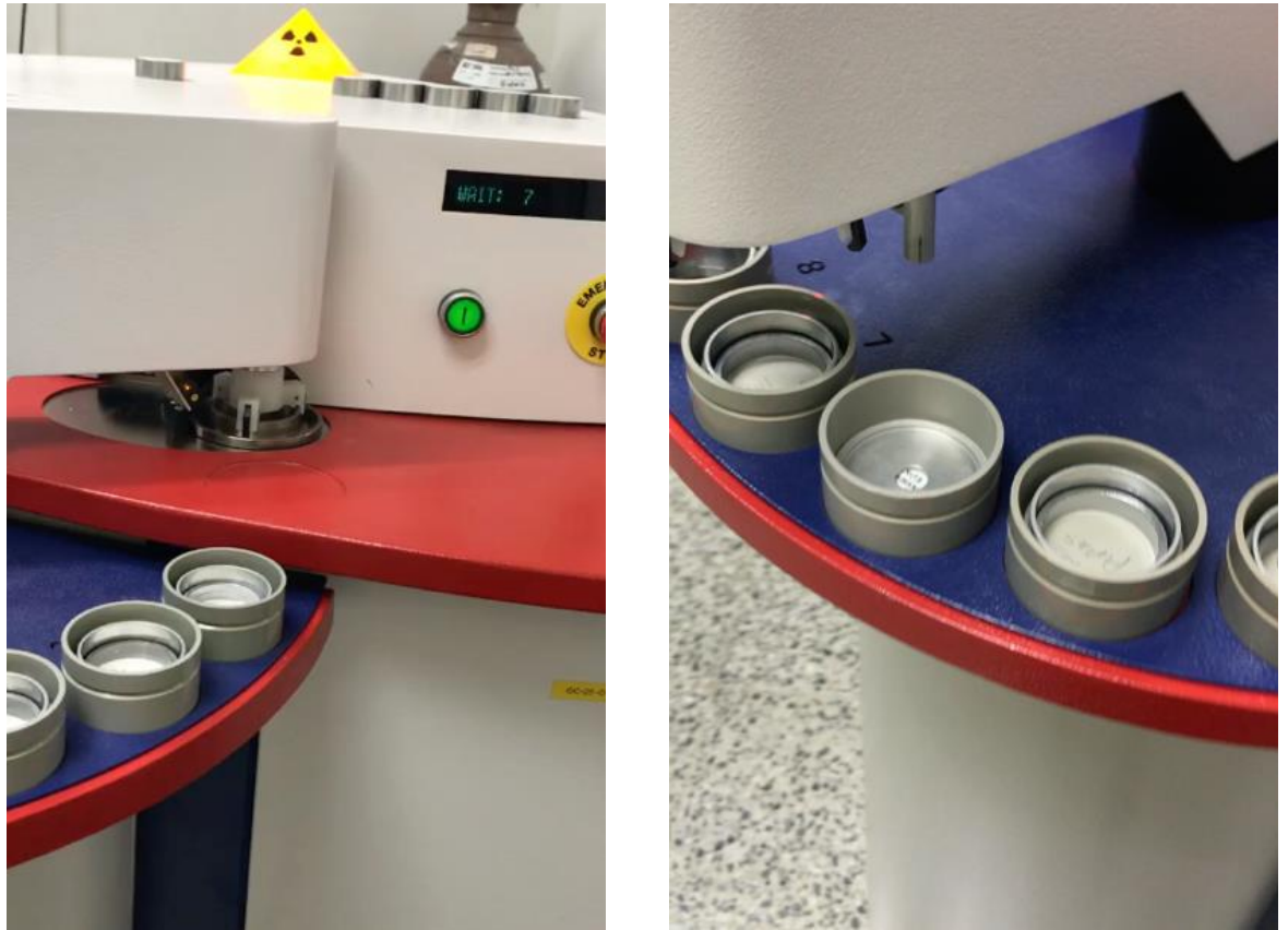
Figura 15. Caracterización de arcillas por fluorescencia de rayos X
