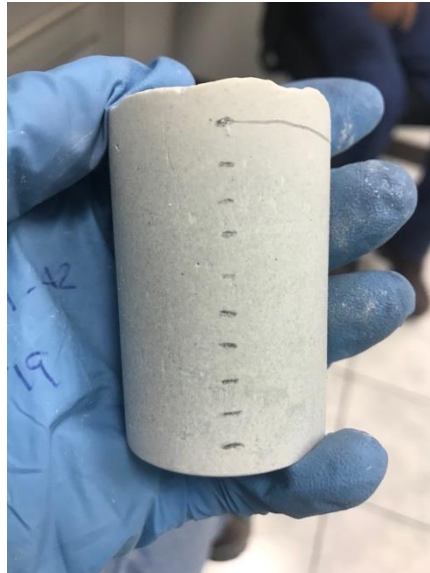
Figura 18. Mezcla de arcilla solidificada desenfrascada, lista para cortar en pastillas
