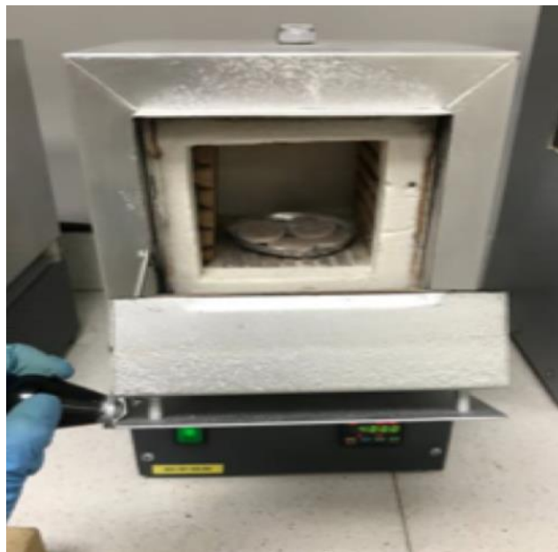
Figura 22. Mufla utiliza para elevar la temperatura de las pastillas a 400°C
