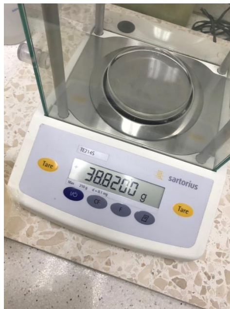
Figura 24. Balanza Analítica empleada para pesar las pastillas para la técnica de agua combinada
