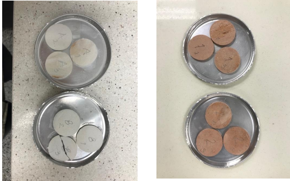
Figura 21. Pastillas cortadas horizontalmente con un grosor aproximado de 1 centímetro en triplicado
