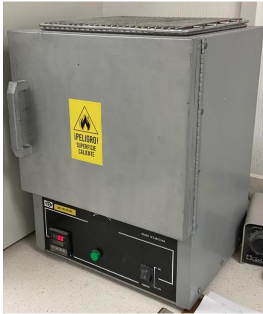
Figura 23. Horno utilizado para llevar las pastillas a una temperatura de 110°C
