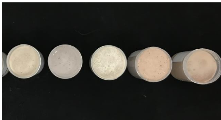
Figura 17. Mezcla para técnica de agua combinada, en frascos para su solidificación
