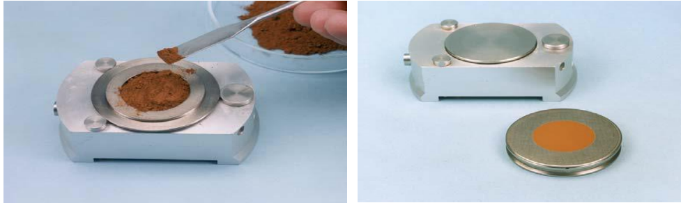
Figura 11. Casete con muestra para análisis de difracción de rayos X (DRX)
