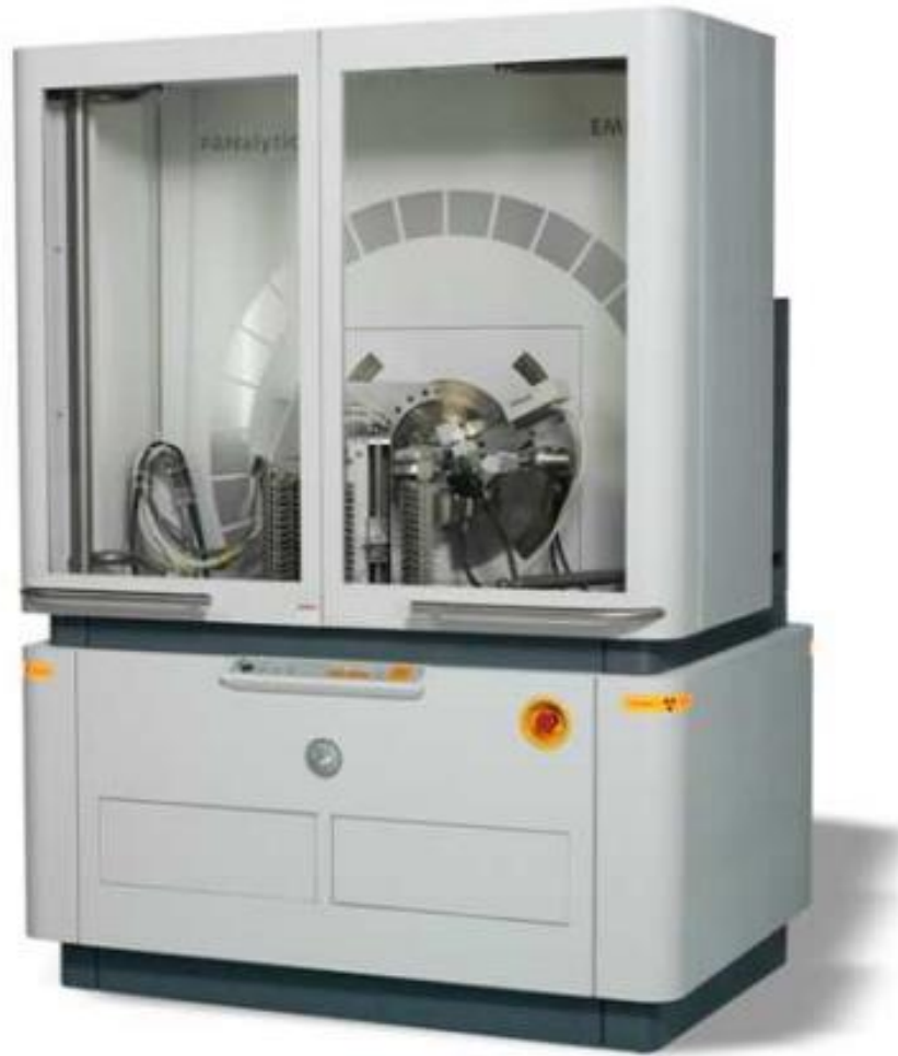
Figura 10. Difracción de rayos X Empyrean PANalytical
