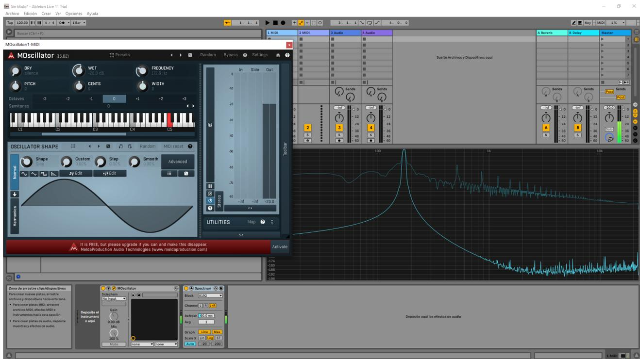
Figura 43. Gráfica del espectro de la forma de onda sinusoidal.
