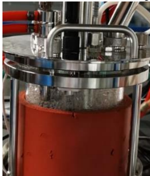
Figura 54. Burbujeo del medio de fermentación al proporcionar aire al reactor.
