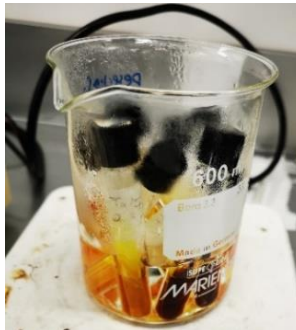
Figura 42. Tubos de ensayo con las muestras en ebullición luego de la hidrólisis enzimática.
