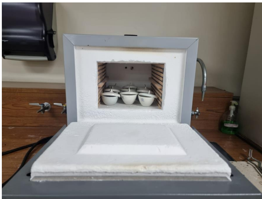
Ilustración 19. Crisoles con muestra de carbón vegetal en mufla.
