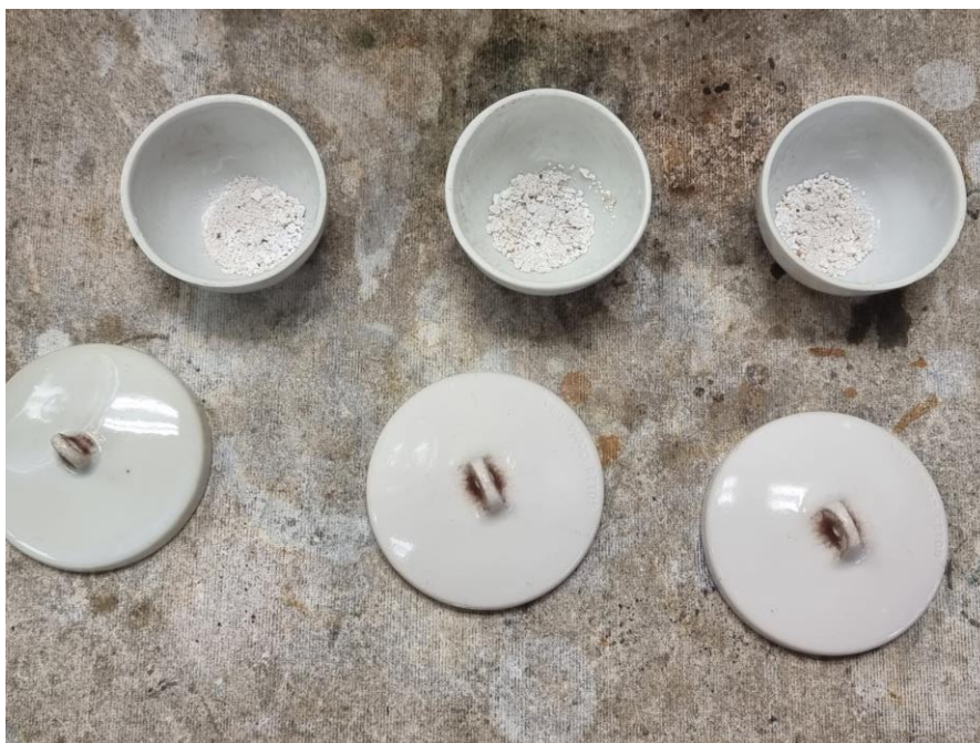
Ilustración 18. Cenizas obtenidas luego de someter a las muestras a tratamiento térmico en la mufla.
