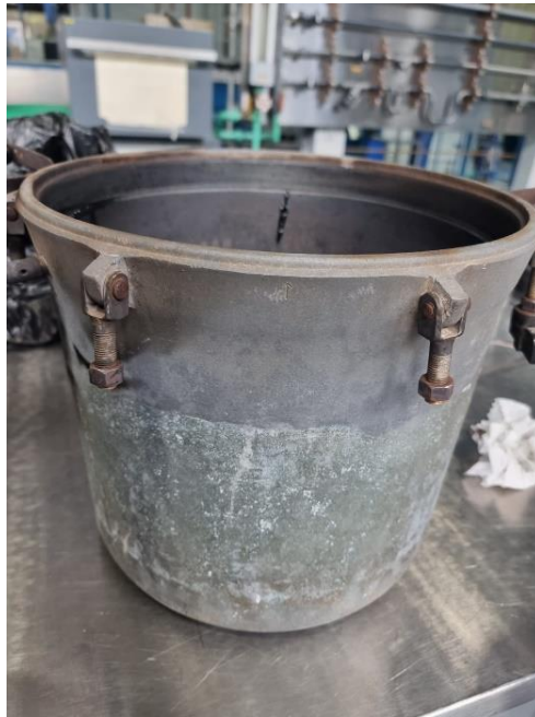
Ilustración 8. Reactor luego de una pirólisis de nueve horas.
