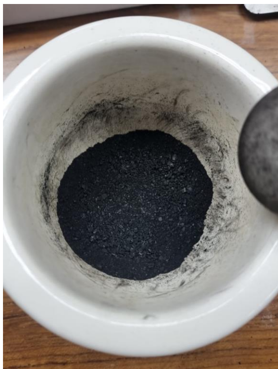
Ilustración 15. Muestra de bio-char molida para la realización del análisis proximal.
