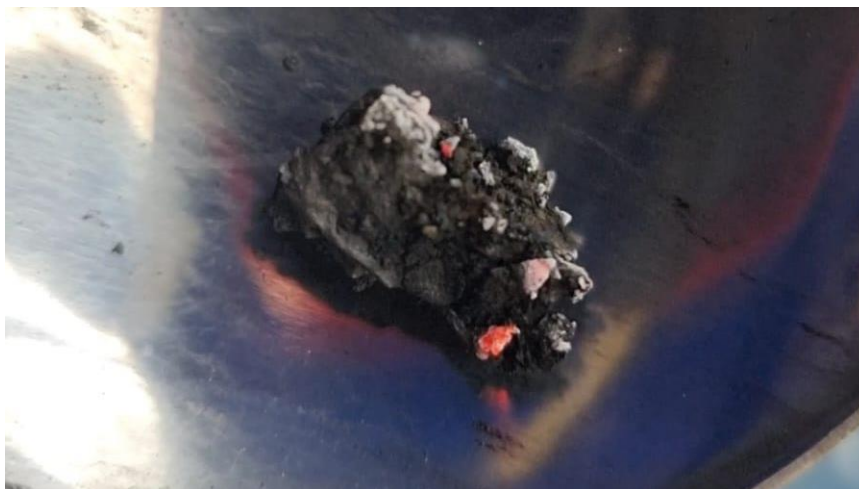
Ilustración 13. Carbón vegetal producido durante la pirólisis en proceso de combustión.
