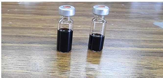
Ilustración 14. Muestras de aceites de pirólisis analizadas en el cromatógrafo de gases con espectrómetro de masas acoplado.
