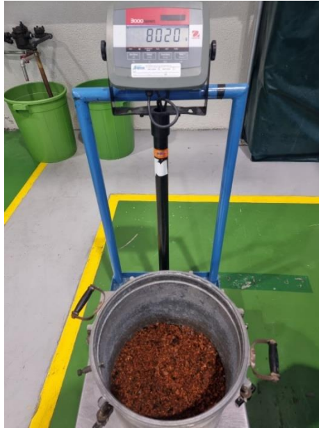
Ilustración 8. Reactor luego de una pirólisis de nueve horas.
