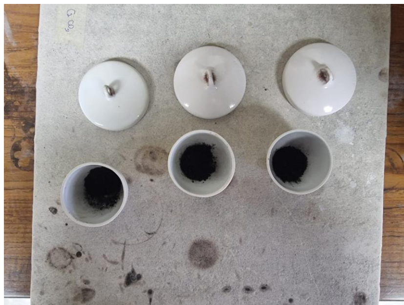
Ilustración 16. Tres muestras de carbón vegetal en crisoles previo a la realización del análisis proximal.
