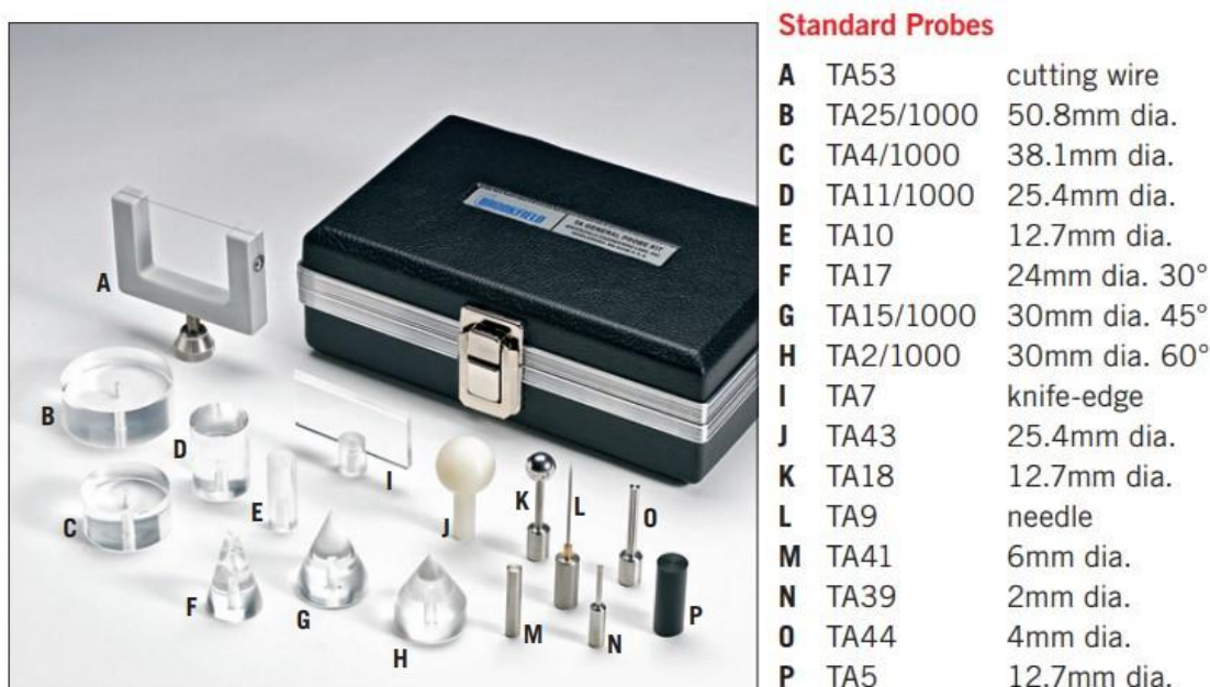
Figura 12. Kit de sondas estándar de Texturómetro Brookfield CT3
