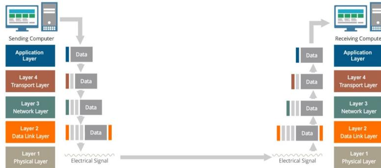
Figura 2: Proceso de comunicación entre dos puntos en una red [11].
