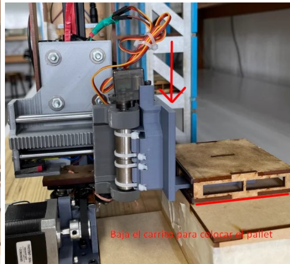
(d) Posición 4 (el carrito vertical baja para dejar el pallet sobre la base)
