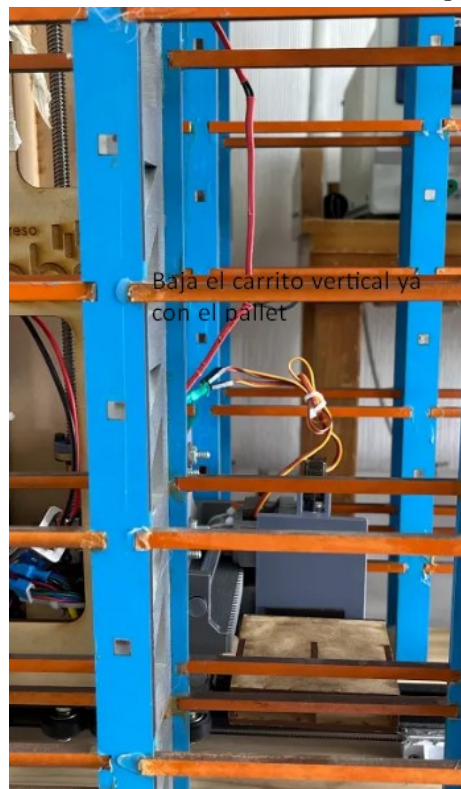
(c) Posición 5 (se retrae la garra y baja el carrito vertical a su posición inicial)
