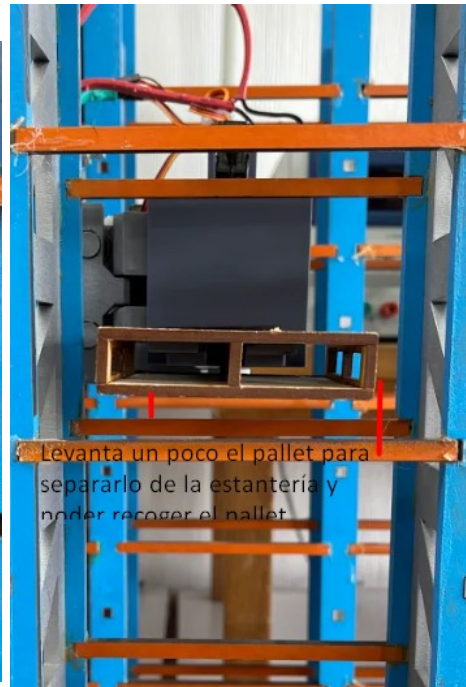
(b) Posición 4 (se mueve la pieza recolectora y sube el carrito vertical para recoger pallet)
