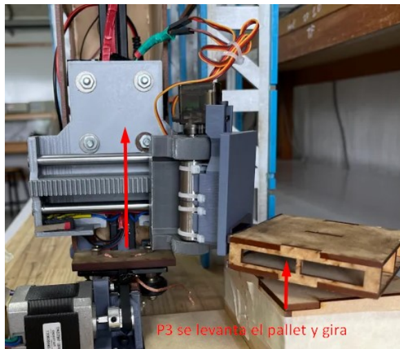
(c) Posición 3 (levanta pallet y se coloca en posición)
