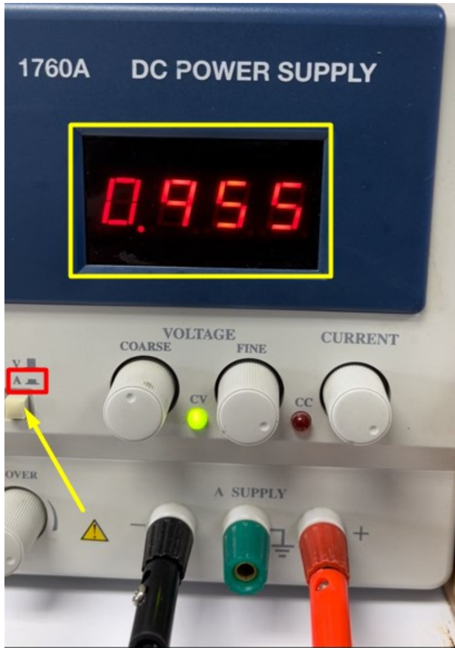
Figura 72: Medición del consumo de corriente con el circuito funcionando
