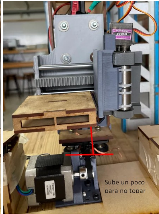
(b) Posición 2 (se eleva el carrito vertical)
