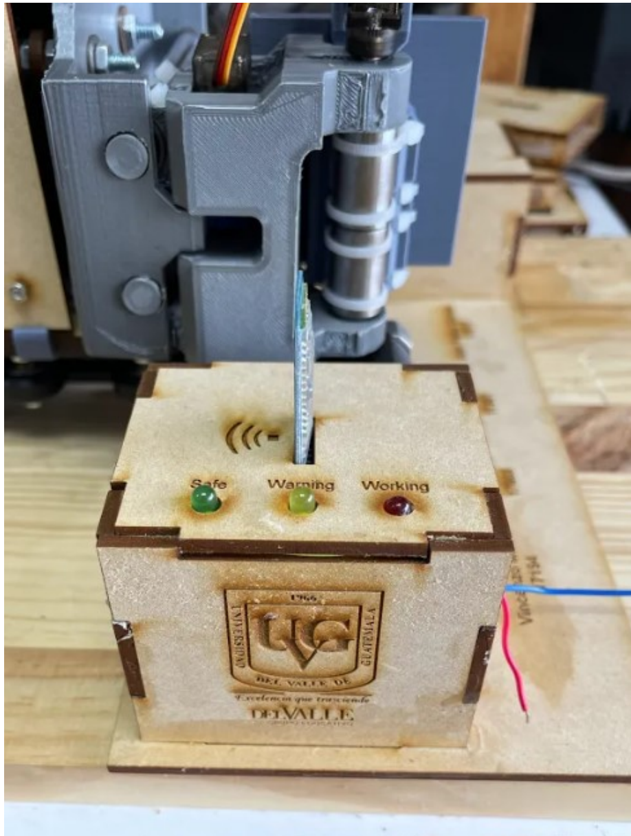
Figura 96: Base y semáforo de operación con comunicación
