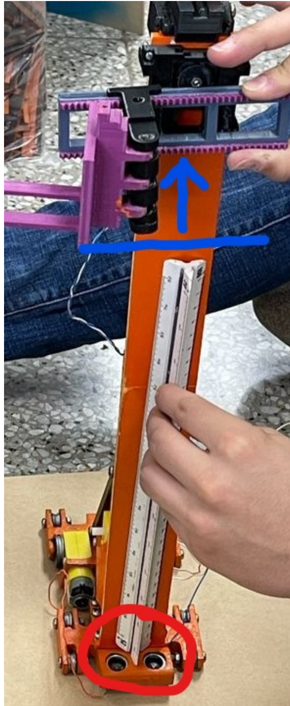
Figura 51: Medición con el sensor ultrasónico y carrito vertical
