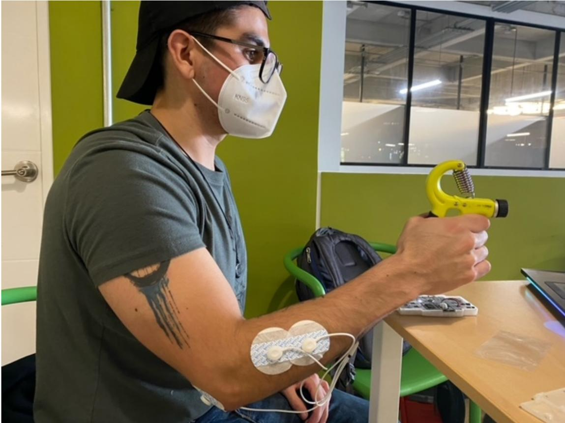
Figura 50: Posicionamiento de electrodos y toma de datos (Grupo2).
