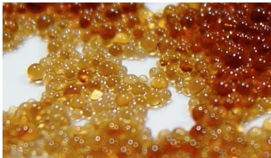
Figura 16. Muestra de resina de intercambio iónico en forma de perla.
