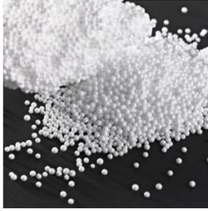
Figura 5. Perlas de poliestireno expandido comercial.
