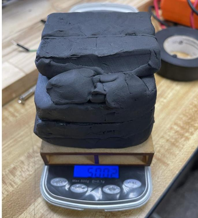
Figura 66: Pallet con carga máxima en balanza, peso: 500.2g
