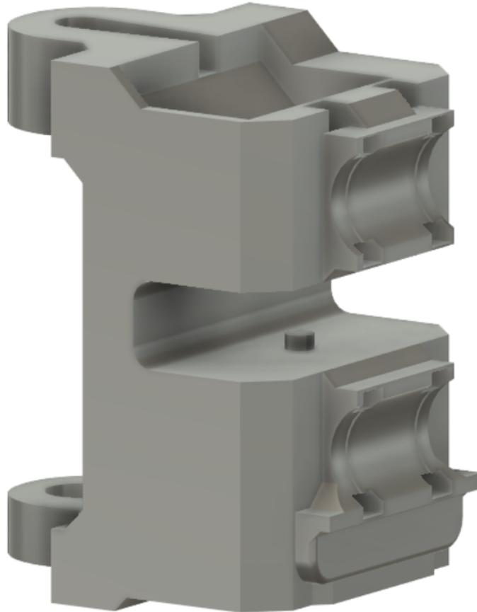
Figura 40: Diseño 3D pieza unión de ejes vista 1
