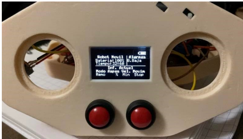
Figura 51: Prueba de funcionamiento de la pantalla Oled.
