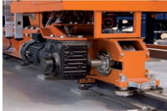
(b) Motor eléctrico y reductor de engranajes
