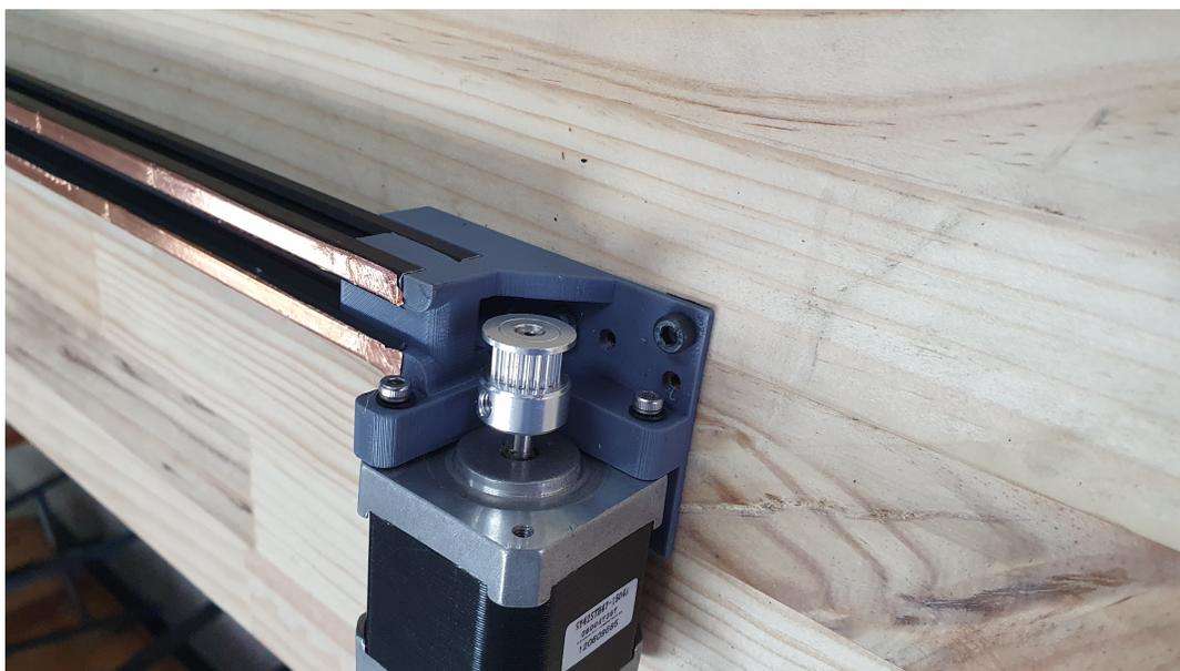
Figura 45: Ensamblaje de pieza de acople entre el motor Nema 17 y el perfil de aluminio segunda iteración
