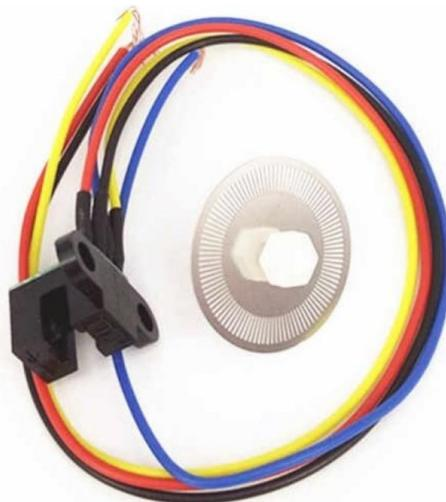
Figura 54: Encoder óptico
