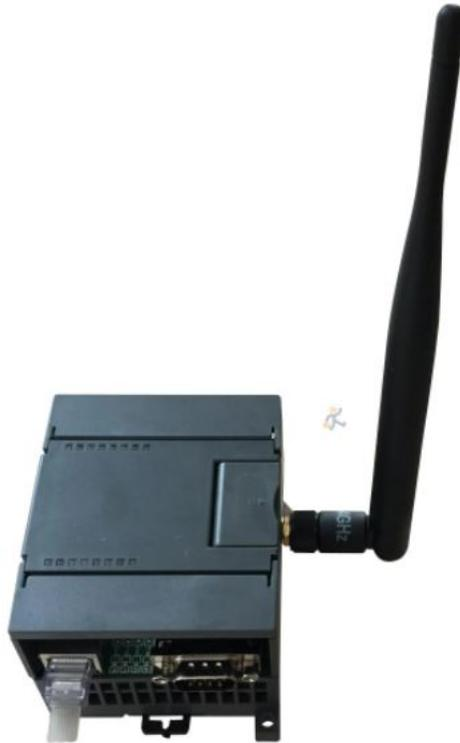
Figura 79: Módulo WI-FI MPI
