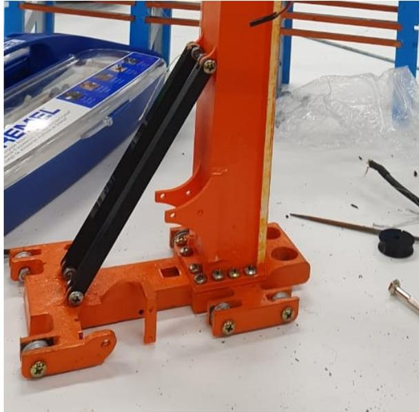
Figura 21: Ensamblaje de pieza base con columna de movimiento vertical primera iteración
