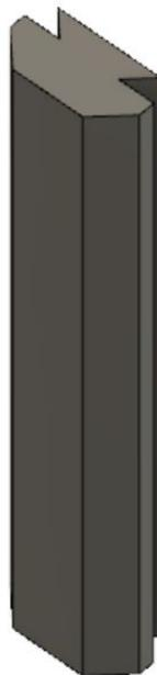
Figura 42: Pieza interna de acople entre perfiles de aluminio.
