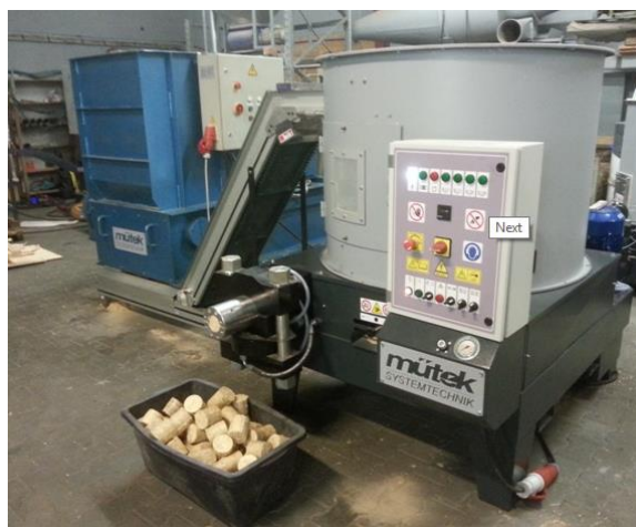
Figura 7. Prensa briquetadora MÜTEK, con flujo de trabajo de 30-550 kg/h.
