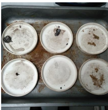
Figura 59. Cenizas de las muestras de almidón de maíz y bagazo de caña.
