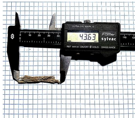
Figura 55. Medición de fibra de bagazo para factores de forma utilizando vernier electrónico.
