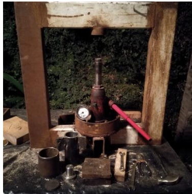
Figura 43. Prototipo de prensa para densificación con capacidad de prensado a 10 MPa.
