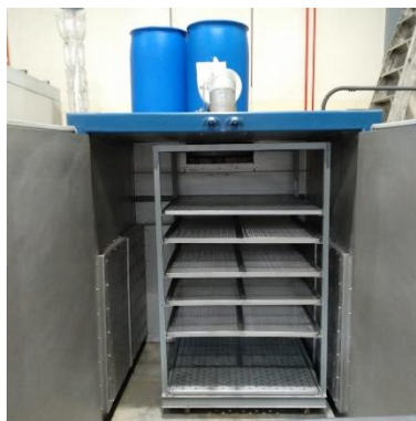
Figura 47. Cámara de secado del secador de bandejas con el camión de bandejas.
