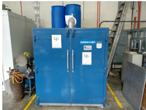
Figura 46. Secador de bandeja CORBETT INDUSTRIES INC, empleado para el secado de bagazo de caña a 60 °C.
