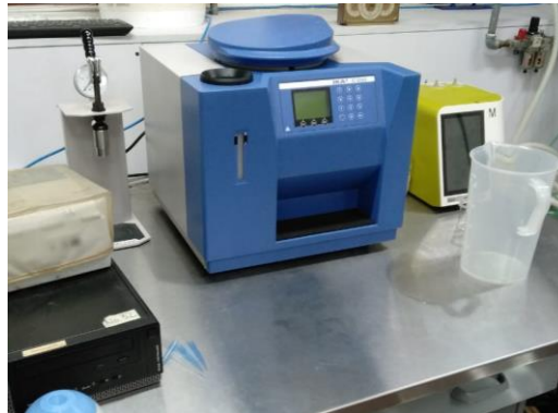
Figura 63. Calorímetro IKA, modelo C 200, empleado para la determinación del PCS de la madera analizada.
