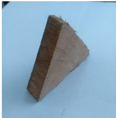
Figura 73. Madera cortada en forma de prisma triangular para la determinación de su densidad.
