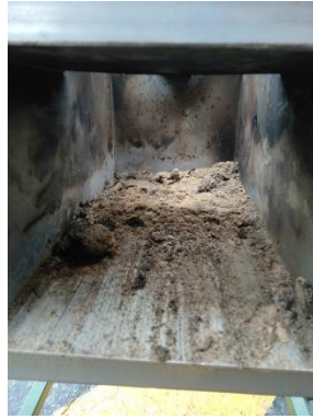
Figura 84. Cenizas de las briquetas al finalizar la combustión.
