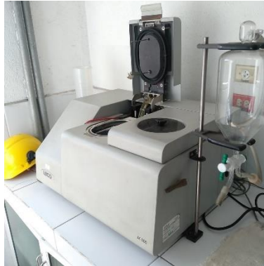
Figura 75. Calorímetro Leco, modelo AC 500, empleado para la medición del PCS en Ingenio San Diego.
