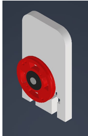
Figura 38: Sistema de sujeción polea de hilo
