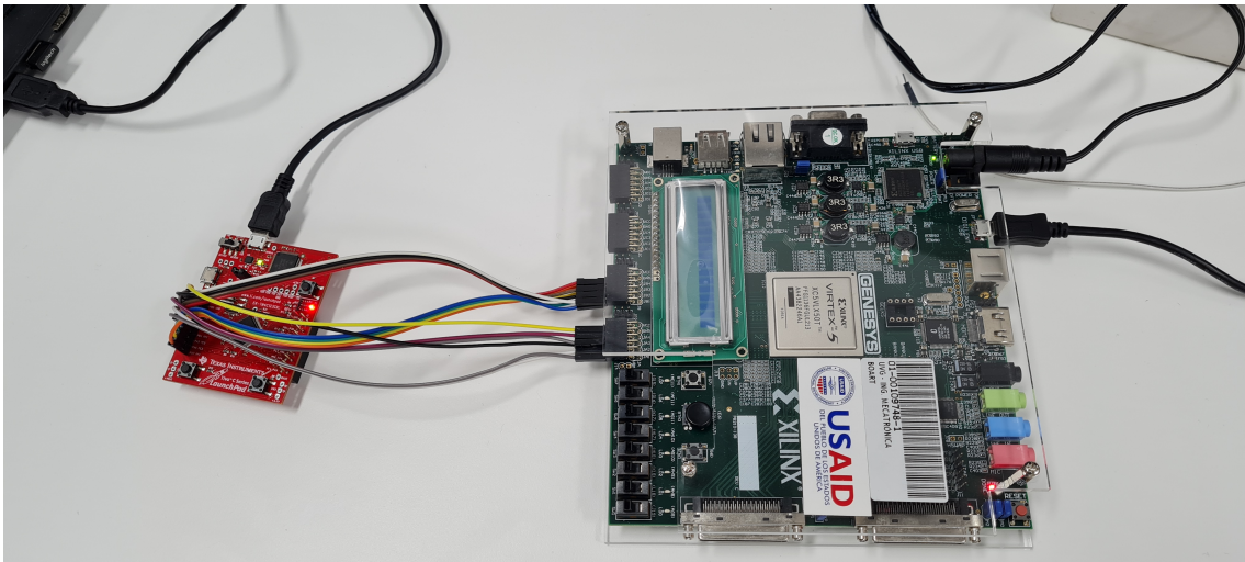
Figura 21: Verificación física de nanochip en pines de expansión a TivaC
