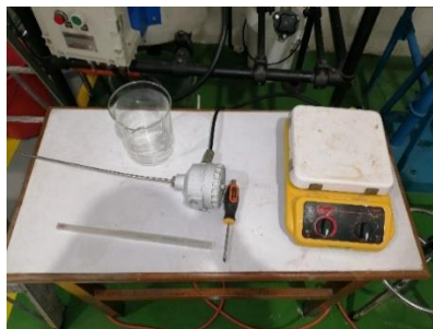
Figura 22. Materiales utilizados para elaborar la curva de calibración de las RTD de temperatura.
