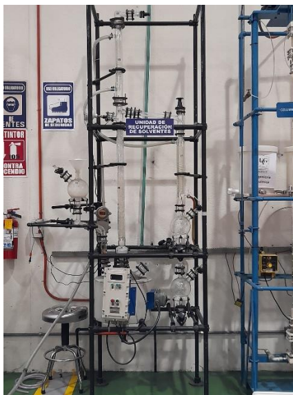
Figura 18. Vista frontal de la unidad de recuperación de solventes.
