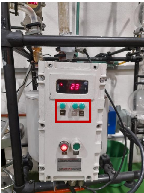
Figura 8. Panel del controlador de temperatura (botones para establecer la temperatura límite).
