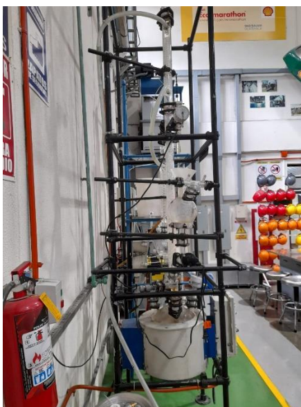
Figura 19. Vista lateral de la unidad de recuperación de solventes.
