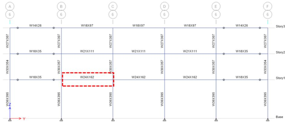
Figura 67. Viga analizada sistema SMF Y
