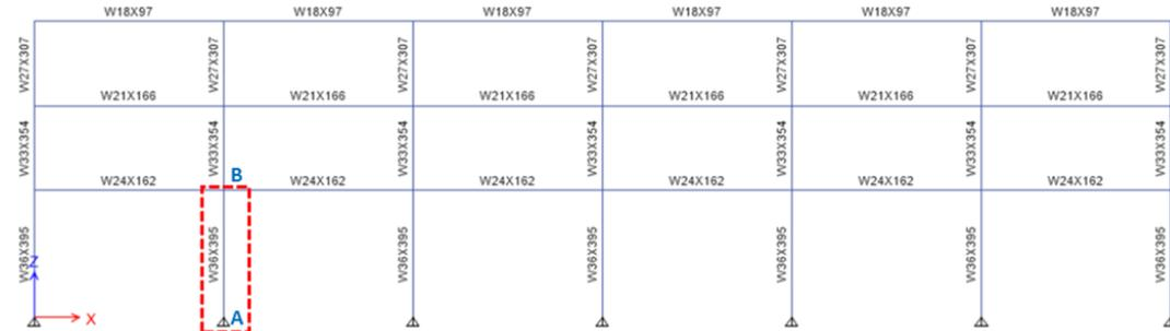
Figura 70. Columna analizada sistema SMF X
