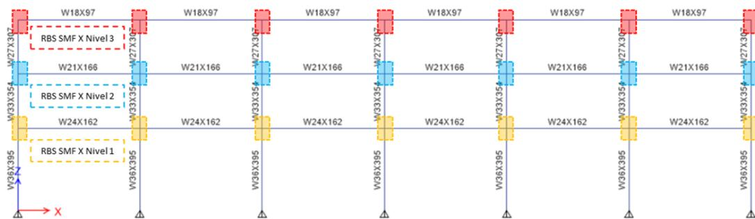
Figura 95. Disposición de conexiones diseñadas sistema SMF X
