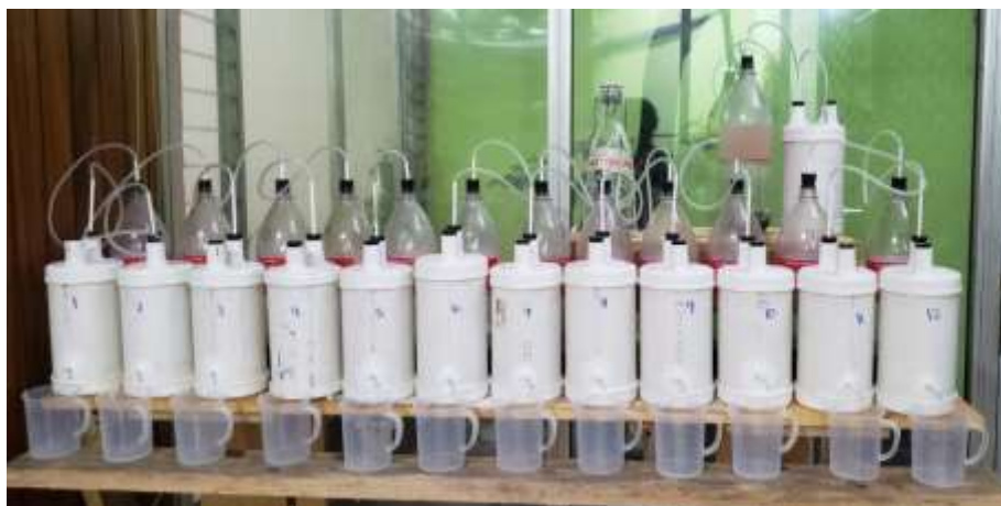
Figura 20. Sistemas de reactor-purificador para producción de biogás.
