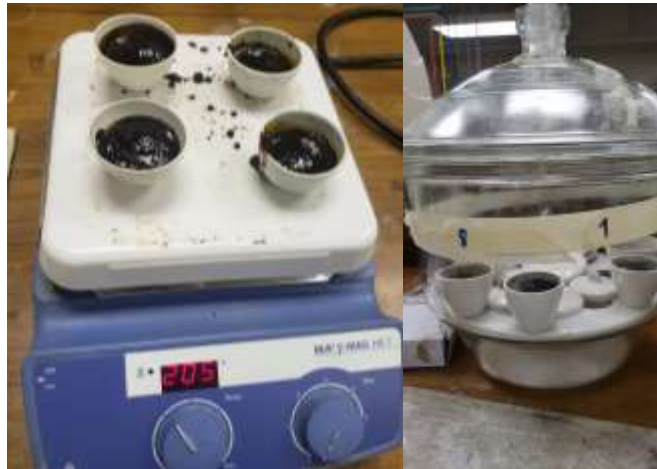
Figura 17. Determinación de sólidos volátiles para cálculo de eficiencia.
