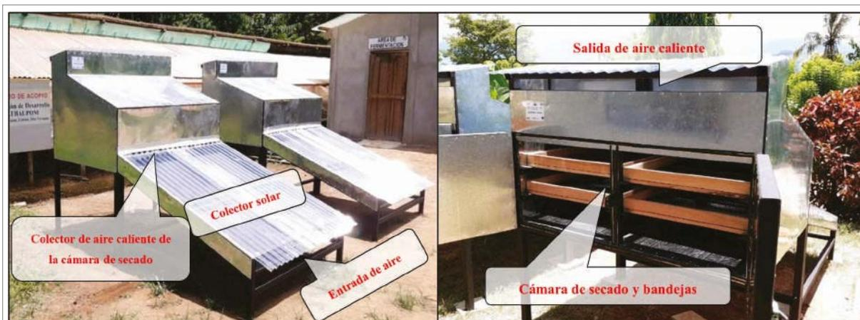
Figura 2. Prototipo de secador solar para cacao fermentado y sus componentes.
