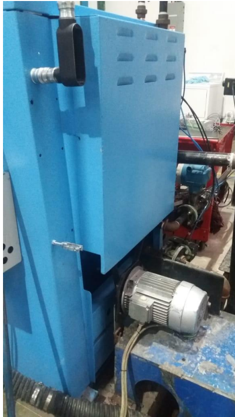
Figura 70: Motor de 4 hp
