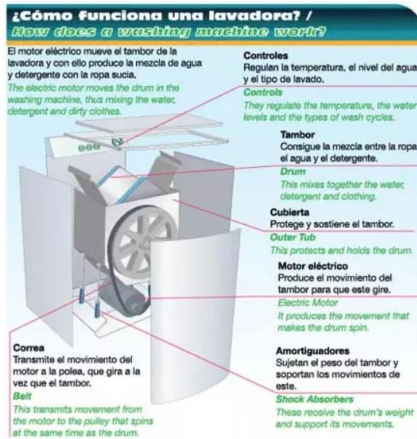
Figura 6: Partes de una lavadora [12]
