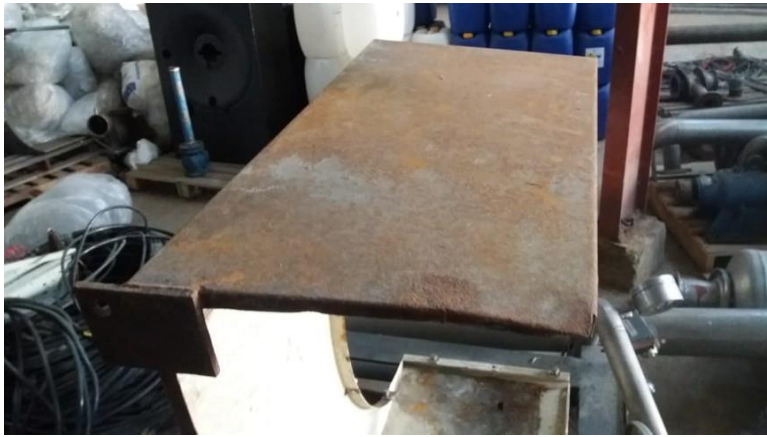
Figura 14: Evaluación de las secciones a reparar del chasis sección lateral
