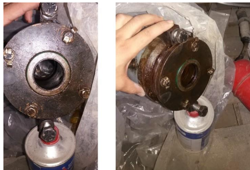
Figura 13: Instalación de sello mecánico
