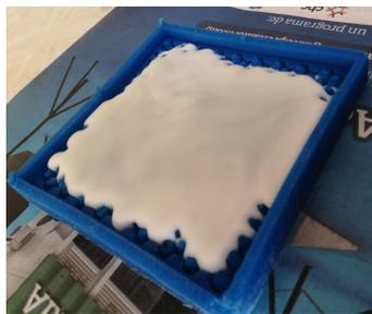
Figura 7.13: Cera procesada en prueba de moldeo
