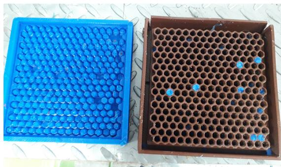
Figura 7.9: Ruptura en molde principal y secundario
