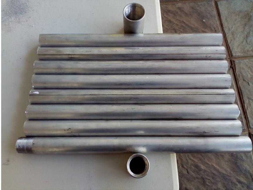
Figura 24: Fotografía de los componentes parásitos: el reflector y los siete directores.
