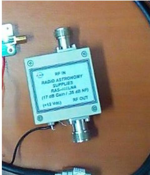
Figura 27: Fotografía del Low Noise Amplifier utilizado en el circuito.
