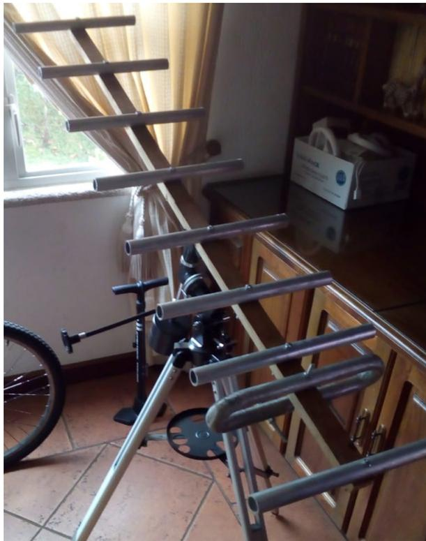
Figura 25: Fotografía de la antena Yagi-Uda montada en un trípode de telescopio.
