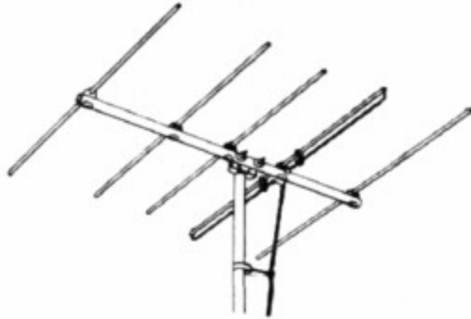
Figura 15: Dibujo de una antena tipo Yagi-Uda con cuatro elementos parásitos y un dipolo doblado.
