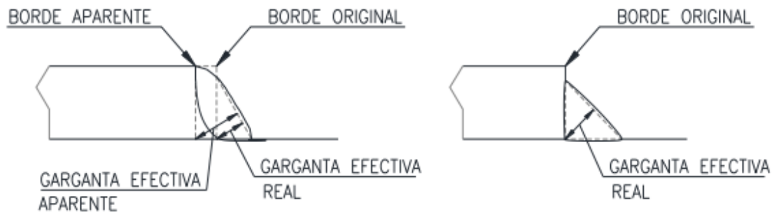
Figura 4. Garganta efectiva de filete
