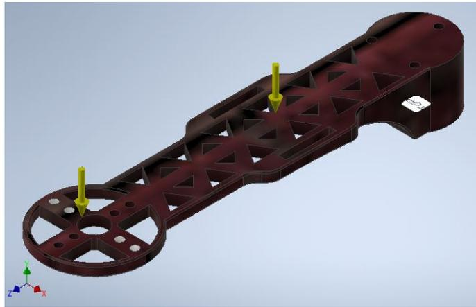
Figura 18: Fuerzas y restricciones para análisis de esfuerzos y deformación.
