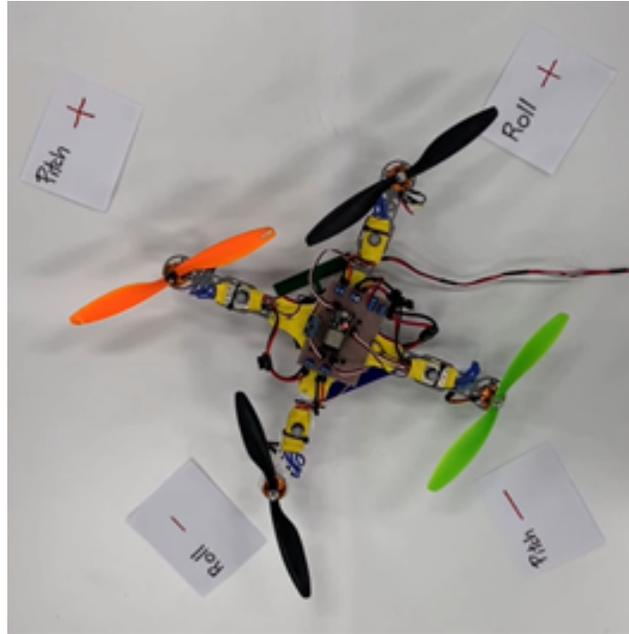
Figura 47: Colocación de direcciones para prueba de modificación de ángulos de rotación.
