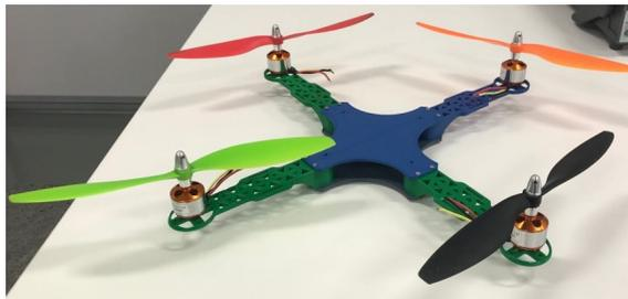
Figura 22: Estructura del cuadricóptero unida con elementos de sujeción.
