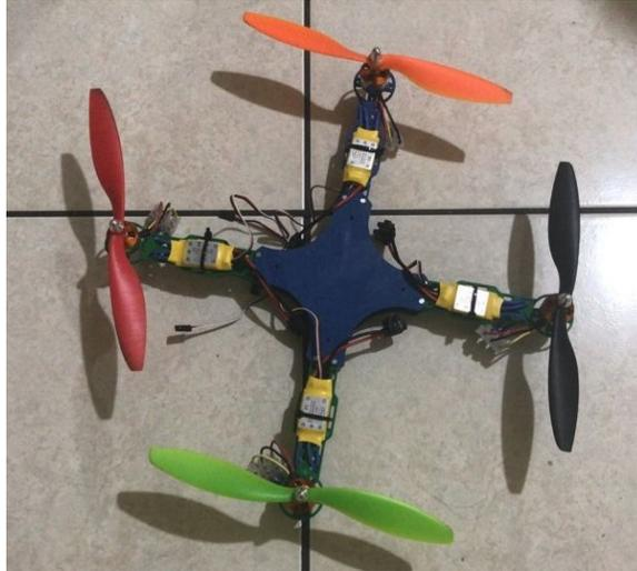
Figura 23: Cuadricóptero ensamblado y conexión de motores con controladores electrónicos de velocidad.
