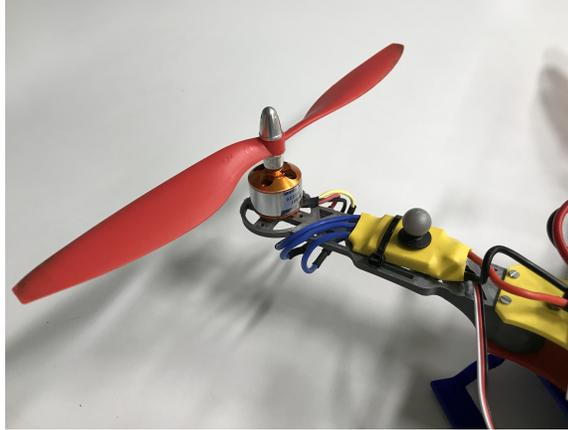
Figura 58: Marcador reflectivo colocado sobre brazo del drone.
