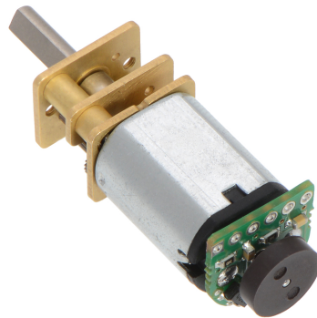
Figura 13: Encoder magnético montado sobre motor [6].
