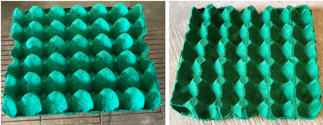
Figura 73. Embalaje para huevos previo y posterior al proceso de secado, creado a partir de 15% de pulpa celulósica de raquis de banano
