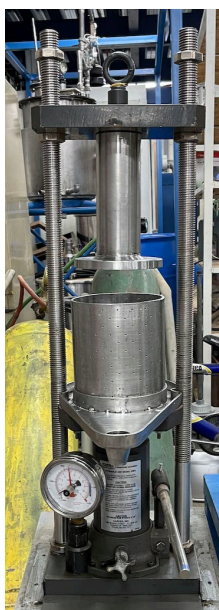
Figura 61. Prensa hidráulica del Laboratorio de Operaciones Unitarias utilizada para pulpa prensada antes al secado
