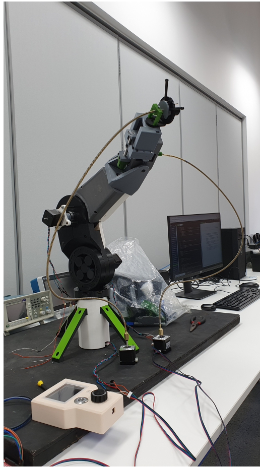
Figura 34: Brazo robótico con los motores y ejes flexibles instalados.
