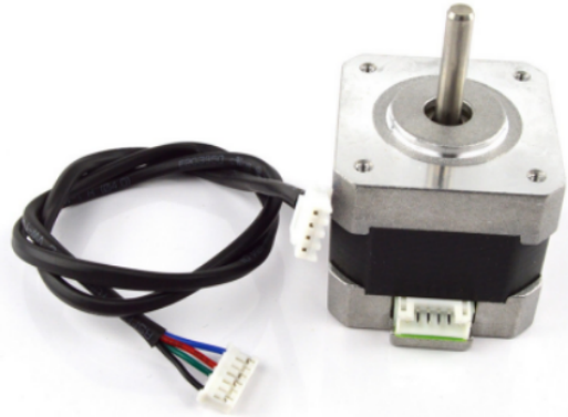
(b) Motor Nema 17 para las juntas 5 y 6
