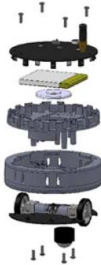
Figura 13: Diagrama de la estructura del robot R-one [10].
