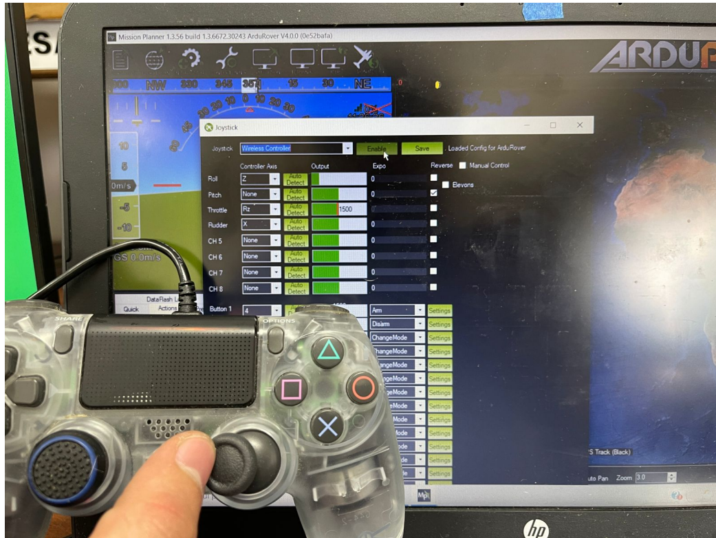
Figura 18: Control de Joystick para canal de Roll (giro)
