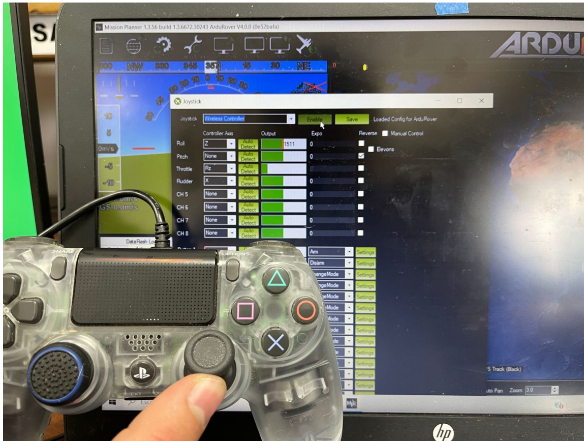
Figura 17: Control de Joystick para canal de Throttle (acelerador)
