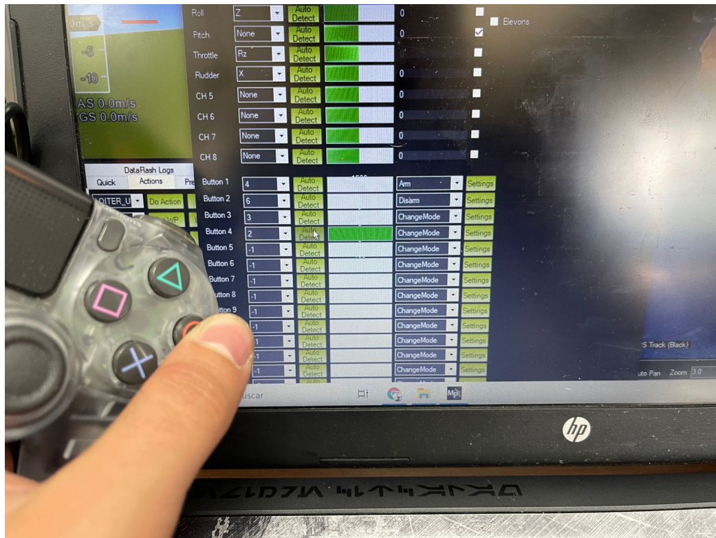
Figura 19: Control de Joystick para canal de cambio de modo
