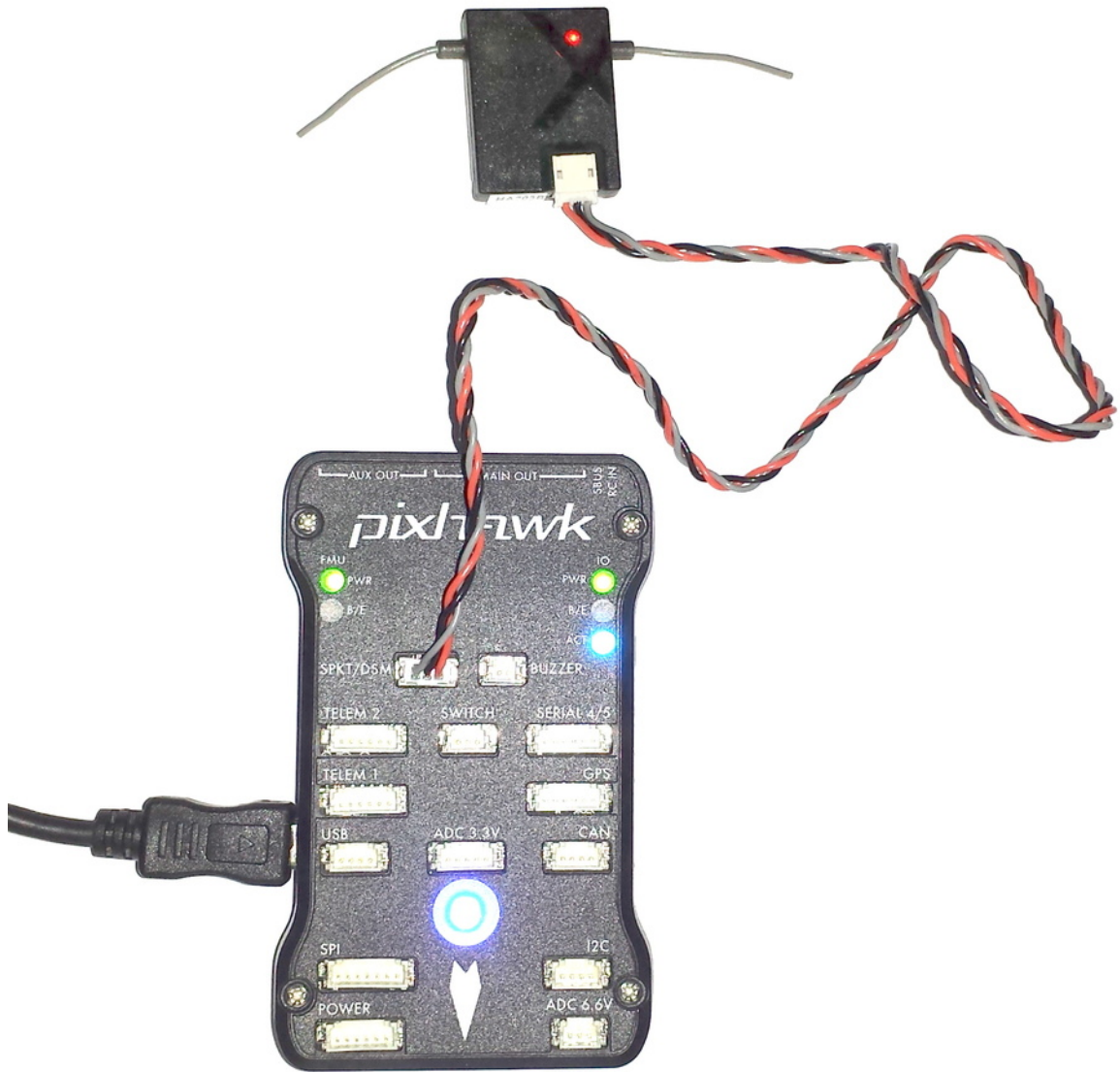
Figura 13: Receptor satélite DSMX conectado a Pixhawk con puerto dedicado
