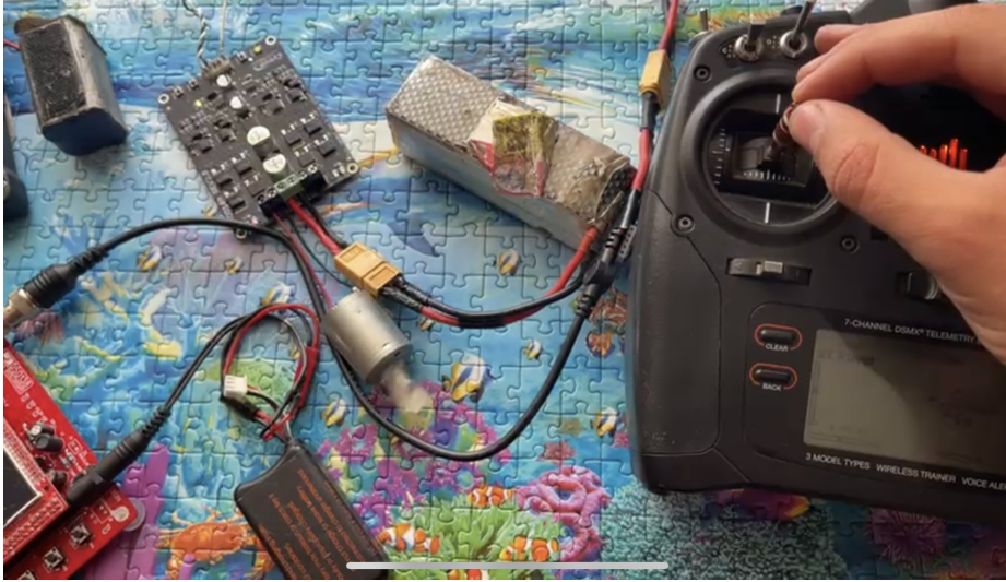
Figura 21: Driver accionando un motor DC a través de señales realizadas en el control RF
