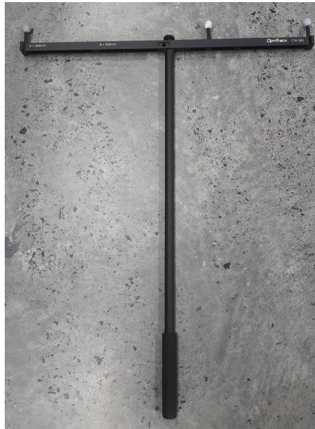
Figura 18: Instrumento usado para el proceso de *wanding*.
