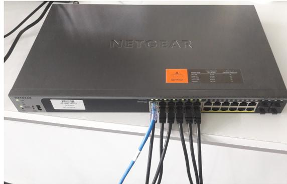
Figura 15: Conexiones de las cámaras y computadora al switch NETGEAR ProSafe GS728TPPv2.
