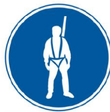
Ilustración #42: Señalización para indicar la obligación de utilización de arneses de seguridad en diversas áreas.
