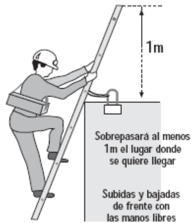
Ilustración #43: Correcta colocación de escaleras de mano.
