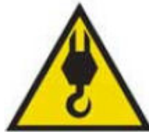
Ilustración #71: Representación gráfica para señalar que se está trabajando con grúas en el área.
