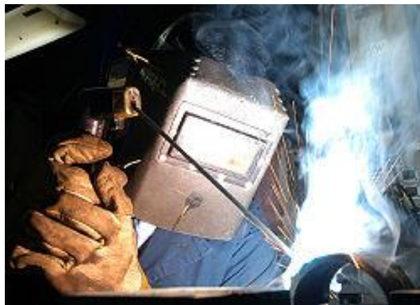
Ilustración #63: Modo correcto de colocar y utilizar la careta de protección visual.
