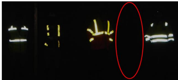
Ilustración #88: Utilización de chaleco reflectivo.
