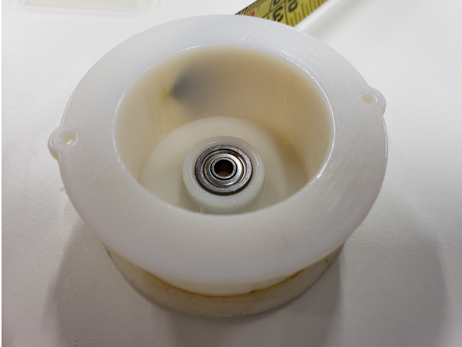
Figura 73: Vista interior del carrete con rodamiento asegurado
