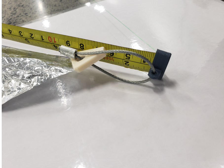
Figura 65: Prueba de pieza de anclaje
