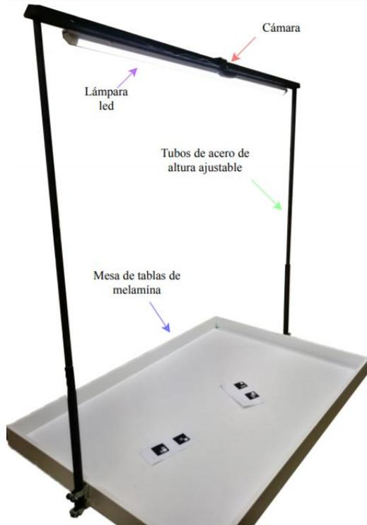
Figura 3: Mesa de prueba Robotat utilizada anteriormente [4].
