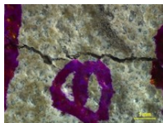
Figura 289: Grieta B del cubo 1 cepa P.5.3.A sin medio de precipitación
