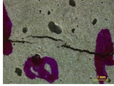
Figura 307: Grieta B del cubo 3 cepa P.5.3.A sin medio de precipitación
