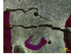
Figura 212: Grieta C del cubo 1 sin cepa con medio de precipitación LUC
