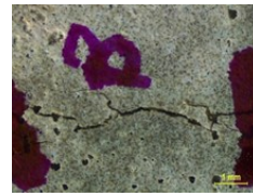
Figura 253: Grieta B del cubo 3 cepa P.4.1.A sin medio de precipitación
