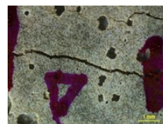
Figura 304: Grieta A del cubo 3 cepa P.5.3.A sin medio de precipitación
