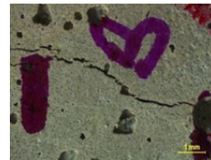
Figura 244: Grieta B del cubo 2 cepa P.4.1.A sin medio de precipitación
