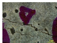
Figura 286: Grieta A del cubo 1 cepa P.5.3.A sin medio de precipitación
