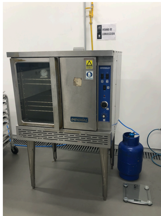
Figura 53. Sistema para cálculo de libras de gas utilizado en horno.
