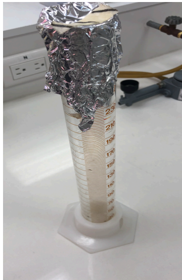
Figura 25. Adición de 225 ml de agua peptonada a muestra sólida.
