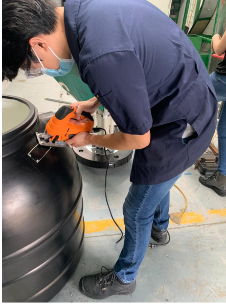
Figura 37: Operación de corte de ventana al depósito
