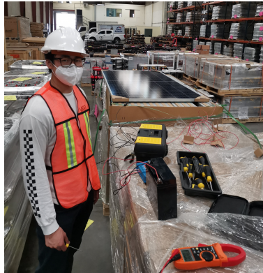
Figura 10: Prueba de estabilidad de voltaje de la batería
