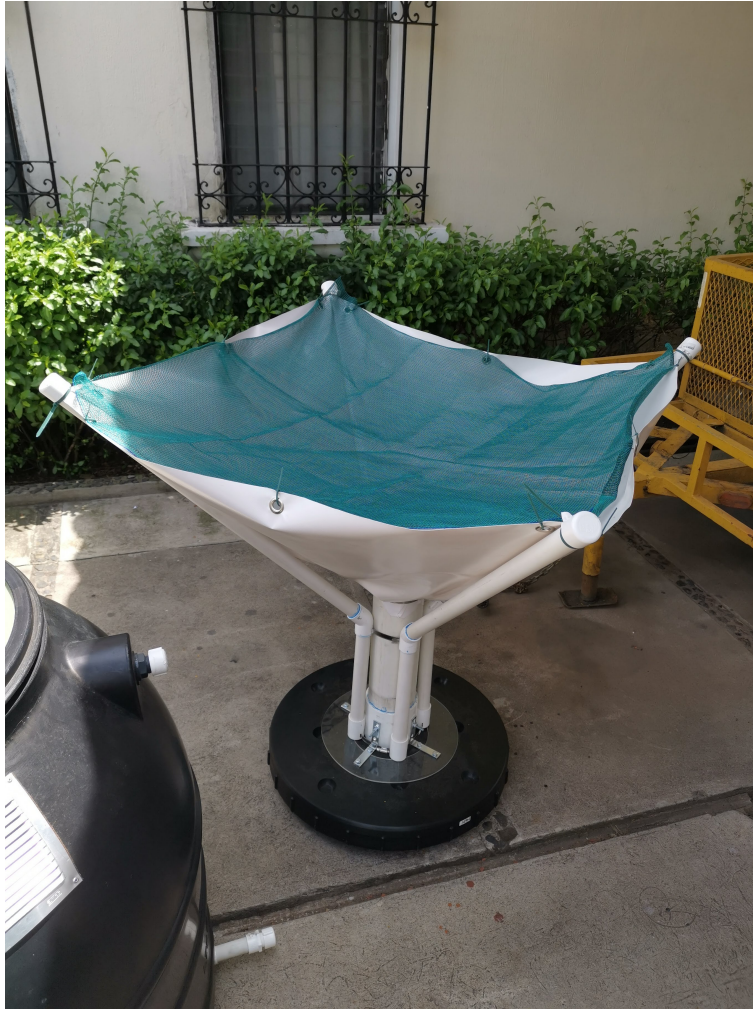
Figura 36: Parte superior terminada del colector de lluvia
