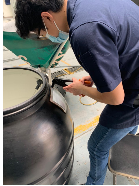
Figura 38: Remachado de esponja y lámina de ventilación
