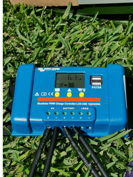
Figura 44: Lectura de la salida de corriente eléctrica del panel solar
