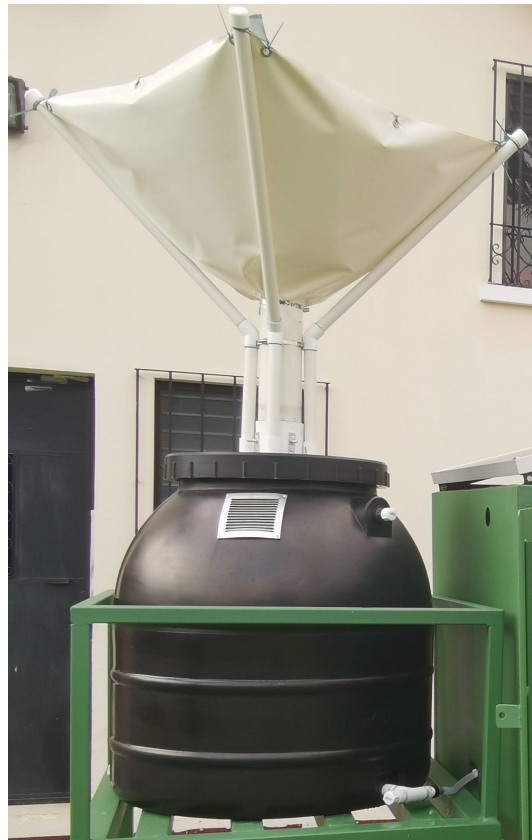
Figura 39: Colector de lluvia terminado
