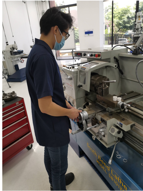
Figura 29: Maquinado de soportes internos de tapadera
