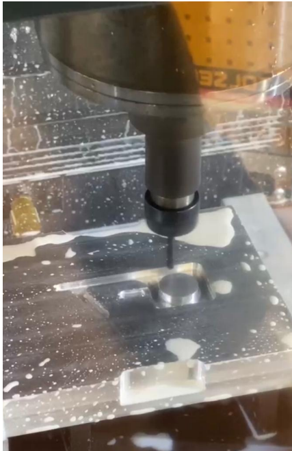
Figura 33: Desbaste de cavidad finalizado y afinado
