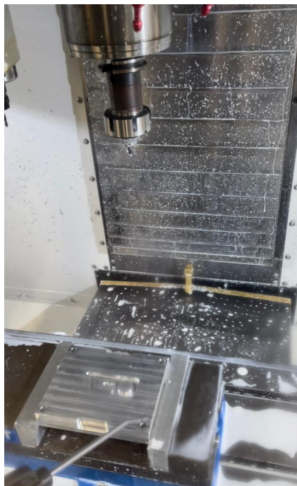
Figura 34: Molde de colada fría finalizado
