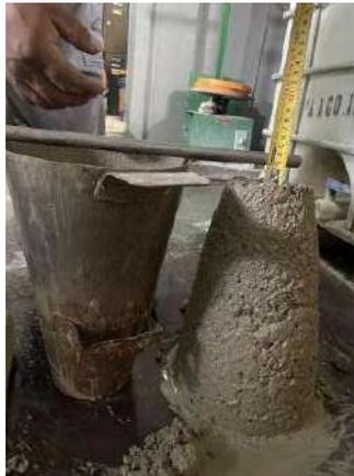
Figura 51. Asentamiento sin aditivo de concreto con 30 % de PET
