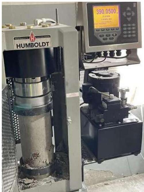
Figura 47. Cilindro 1. Resistencia a compresión a los 28 días con 20 % de PET
