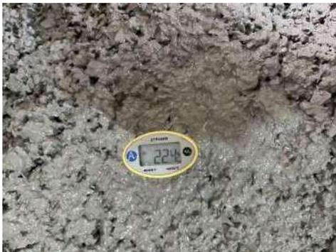
Figura 71. Temperatura de concreto con 50 % dePET
