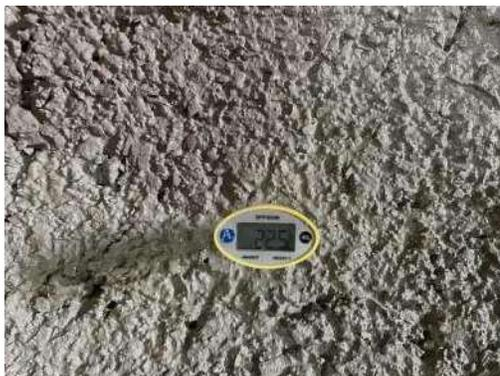
Figura 62. Temperatura de concreto con 40 % de PET
