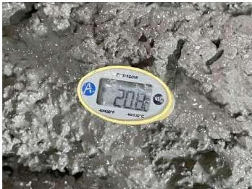
Figura 31. Temperatura de concreto con 0 % de PET
