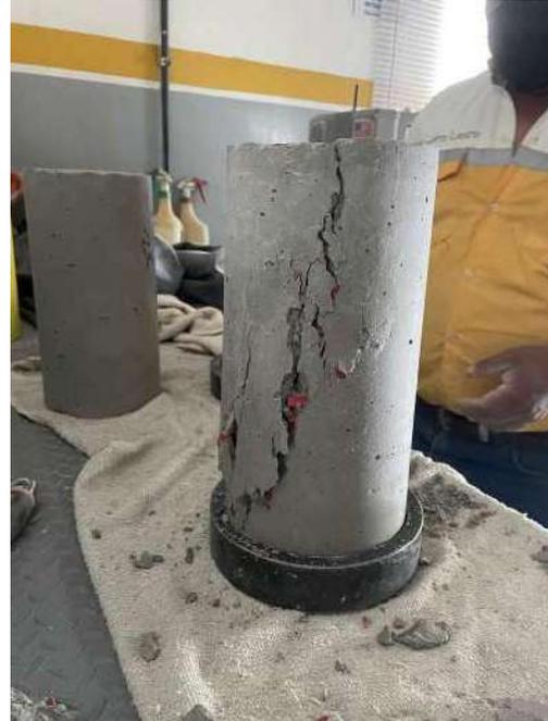
Figura 59. Cilindro 2. Grieta de cilindro después de ensayo a compresión con 30 % de PET
