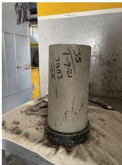
Figura 66. Cilindro 1. Grieta de cilindro después de ensayo a compresión con 40 % de PET
