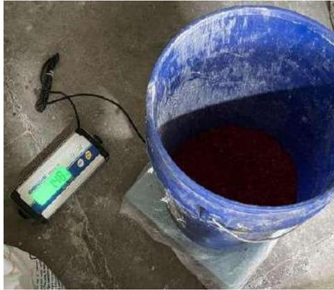
Figura 12. Báscula ADAM CPW plus-35 utilizada para la realización de los ensayos.
