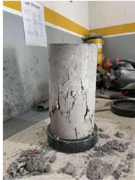
Figura 50. Cilindro 2. Grieta de cilindro después de ensayo a compresión con 20 % de PET
