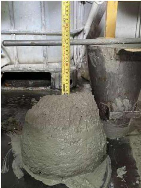
Figura 34. Asentamiento con aditivo en concreto con 10 % de PET
