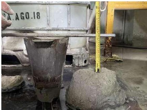
Figura 30. Asentamiento con aditivo en concreto con 0 % de PET
