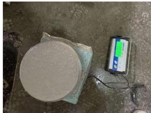
Figura 54. Peso de concreto con 30 % de PE
