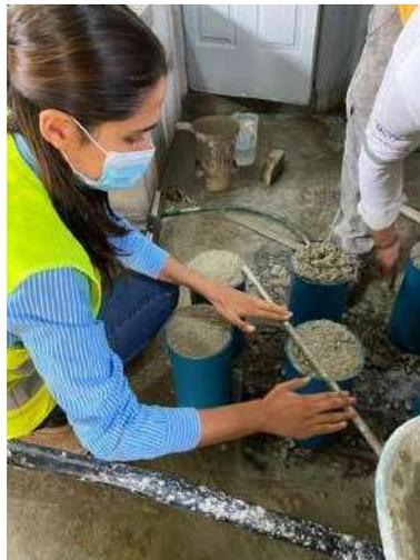
Figura 16. Varilla utilizada para compactar
