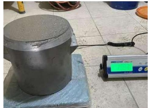
Figura 72. Peso de concreto con 50 % de PET
