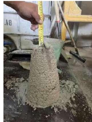
Figura 70. Asentamiento con aditivo en concreto con 50 % de PET
