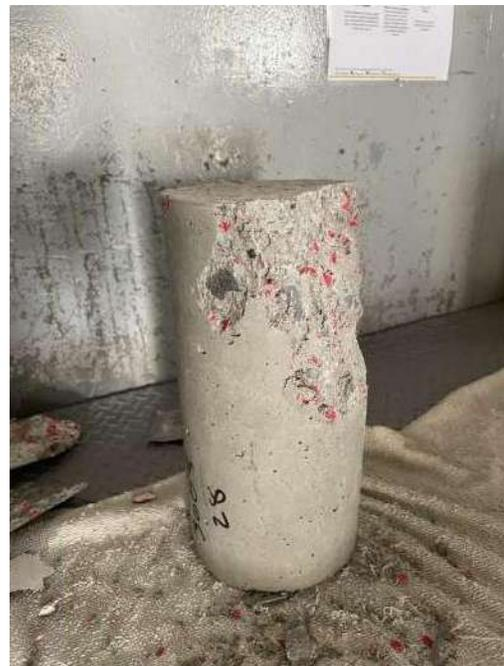
Figura 57. Cilindro 1. Grieta de cilindro después de ensayo a compresión con 30 % de PET
