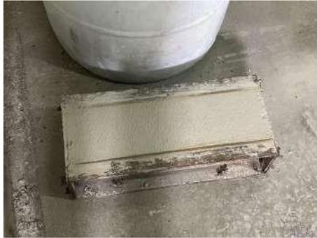
*Figura 23. Molde de viga*
