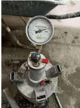
Figura 73. Porcentaje de aire de concreto con 50 % de PET
