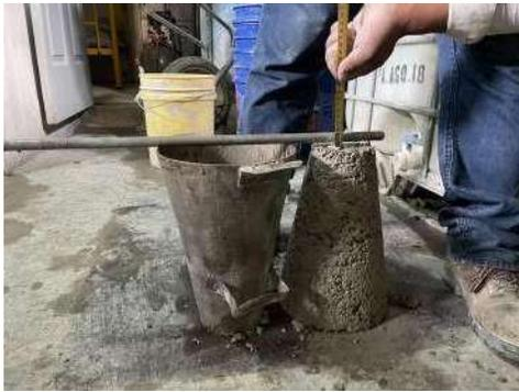
Figura 69. Asentamiento sin aditivo de concreto con 50 % de PET
