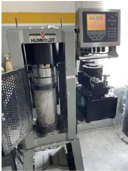
Figura 49. Cilindro 2. Resistencia a compresión a los 28 días con 20 % de PET
