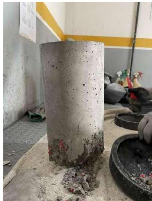
Figura 48. Cilindro 1. Grieta de cilindro después de ensayo a compresión con 20 % de P
