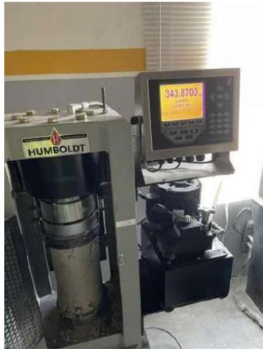
Figura 67. Cilindro 2. Resistencia a compresión a los 28 días con 40 % de PET
