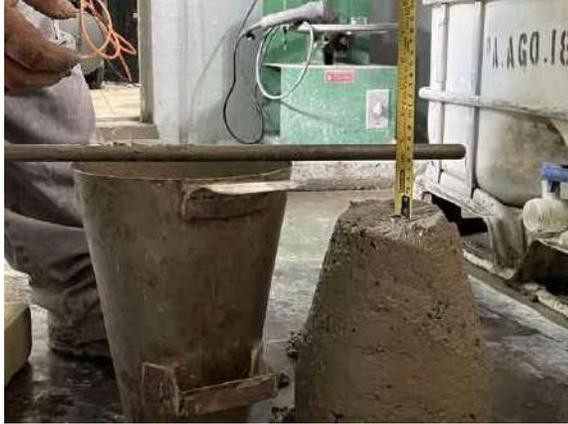
Figura 29. Asentamiento sin aditivo de concreto con 0 % de PET
