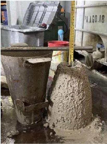
Figura 42. Asentamiento sin aditivo de concreto con 20 % de PET
