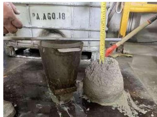
Figura 52. Asentamiento con aditivo en concreto con 30 % de PET
