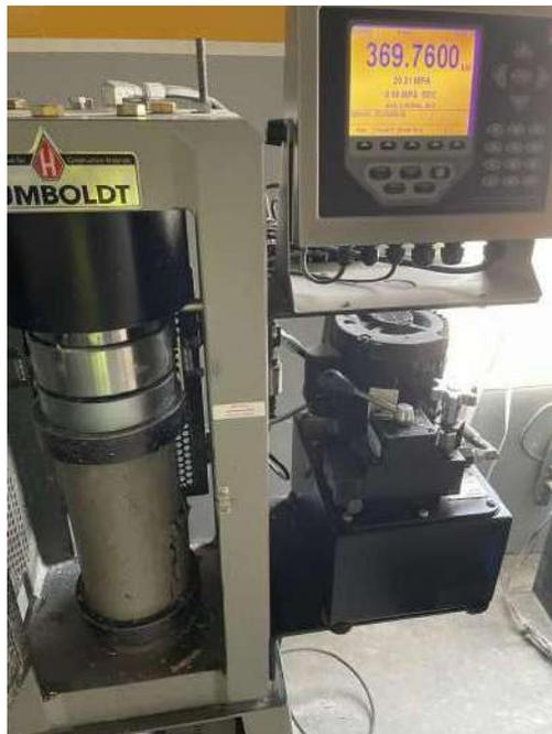
Figura 56. Cilindro 1. Resistencia a compresión los 28 días con 30 % de PET
