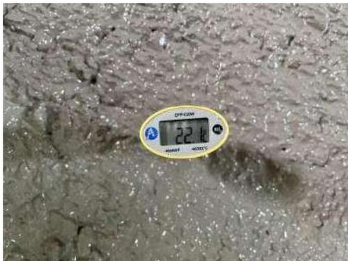
Figura 44. Temperatura de concreto con 20 % de PET
