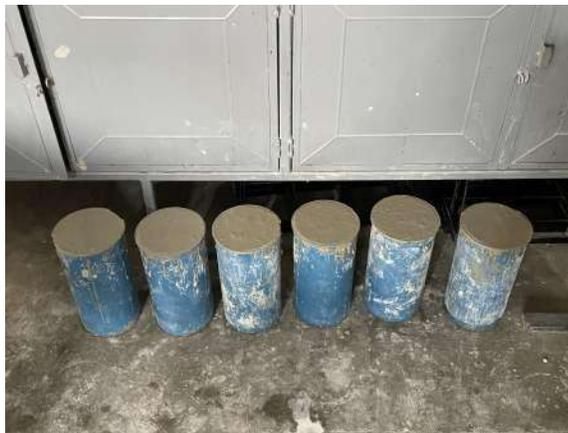
Figura 22. Moldes de cilindros
