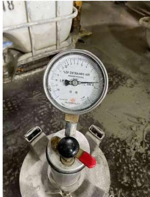
Figura 35. Porcentaje de aire de concreto con 10 % de PET
