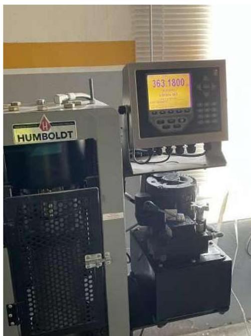
Figura 65. Cilindro 1. Resistencia a compresión los 28 días con 40 % de PET
