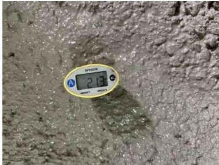
*Figura 19.* Dispositivo para medición de temperatura Cooper-Atkins DFP450
