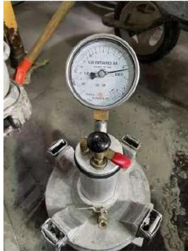
Figura 55. Porcentaje de aire de concreto con 30 % de PET
