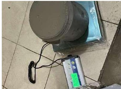
Figura 32. Peso de concreto con 0 % de PET
