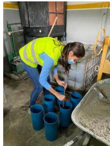
Figura 17. Varilla utilizada para compactar
