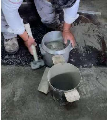
*Figura 18.* Mazo utilizado en los ensayos
