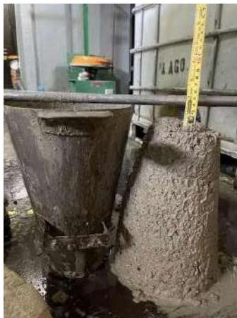
Figura 60. Asentamiento sin aditivo de concreto con 40 % de PET
