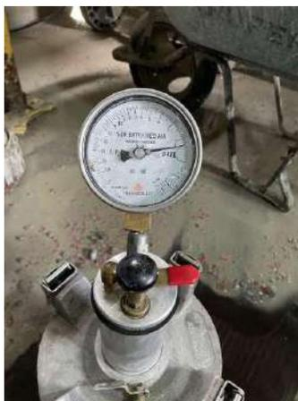
Figura 64. Porcentaje de aire de concreto con 40 % de PET
