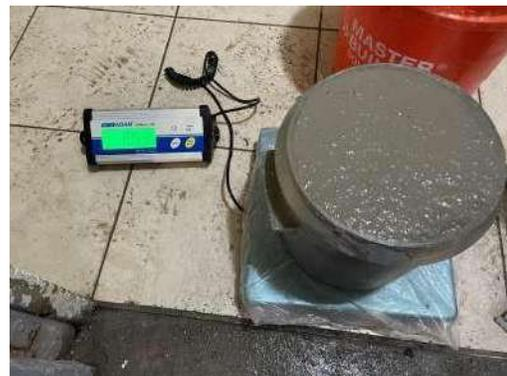
Figura 63. Peso de concreto con 40 % de PET
