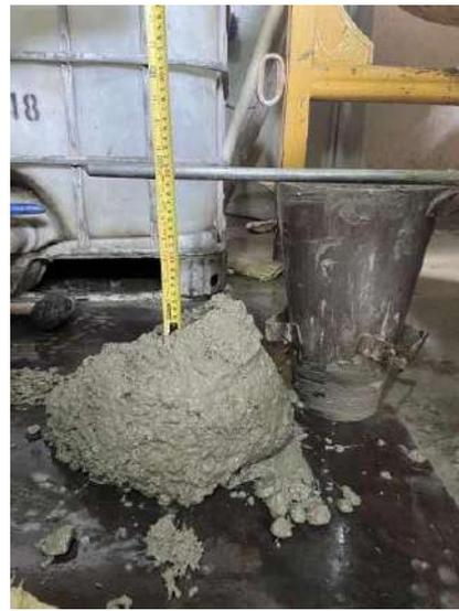
Figura 43. Asentamiento con aditivo en concreto con 20 % de PET
