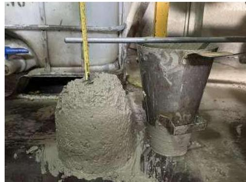
Figura 61. Asentamiento con aditivo en concreto con 40 % de PET
