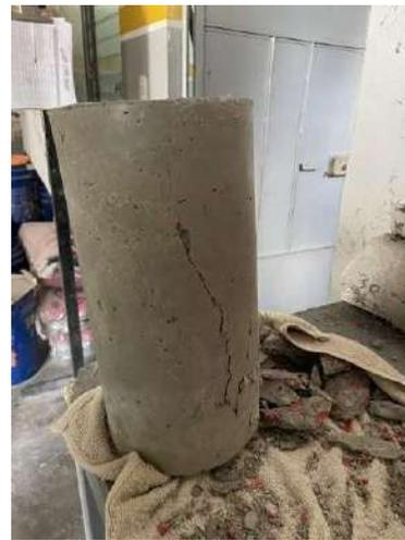
Figura 68. Cilindro 2. Grieta de cilindro después de ensayo a compresión con 40 % de PET
