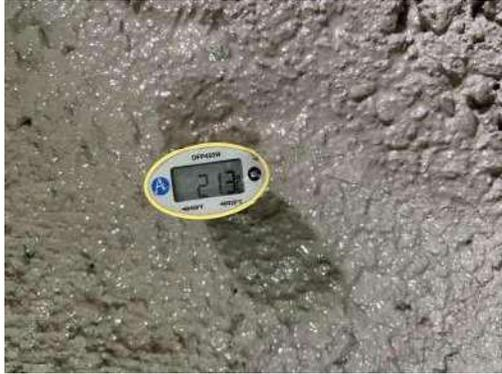
Figura 36. Temperatura de concreto con 10 % de PET
