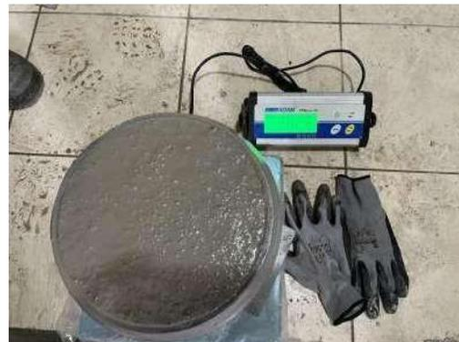
Figura 45. Peso de concreto con 20 % de PET
