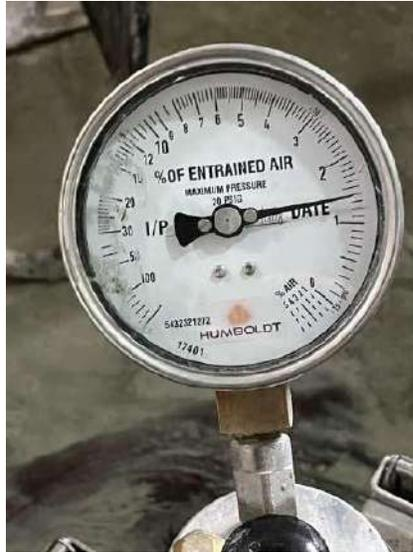
Figura 33. Porcentaje de aire de concreto con 0 % de PET
