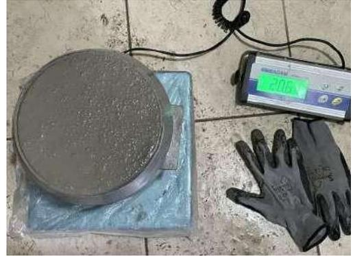
Figura 37. Peso de concreto con 10 % de PET
