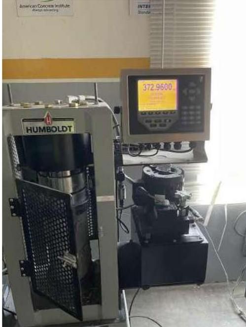
Figura 58. Cilindro 2. Resistencia a compresión a los 28 días con 30 % de PET
