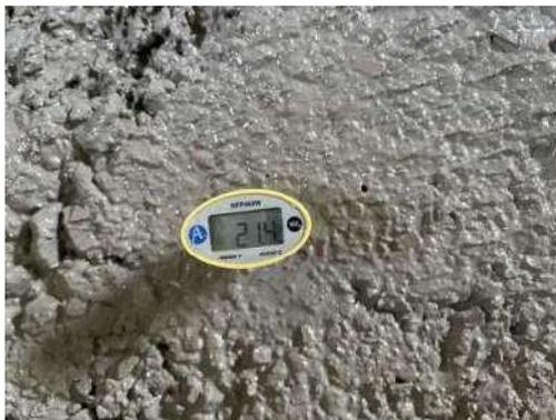
Figura 53. Temperatura de concreto con 30 % de PET
