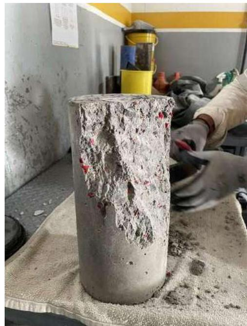
Figura 39. Cilindro 1. Grieta de cilindro después de ensayo a compresión con 10 % de PE
