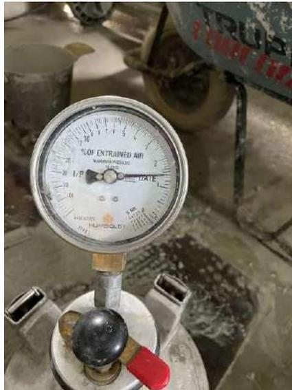
Figura 46. Porcentaje de aire de concreto con 20 % de PET
