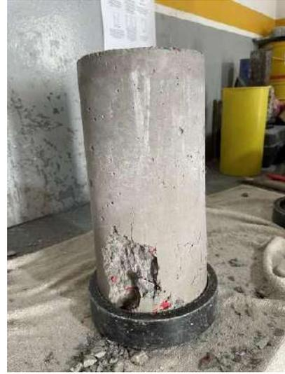
Figura 41. Cilindro 2. Grieta de cilindro después de ensayo a compresión con 10 % de PET
