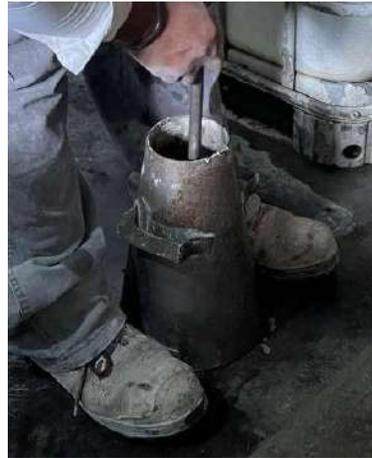
Figura 15. Cono de Abrams utilizado para la realización de los ensayos.
