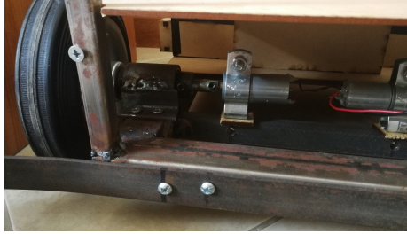
Figura 15: Eje de llantas con tracción del primer prototipo
