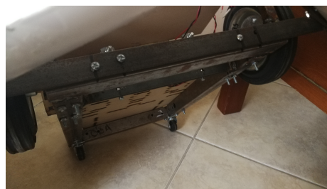
Figura 14: Distribución de llantas de primer prototipo
