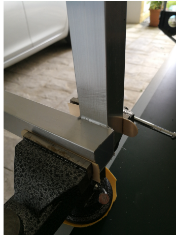
Figura 27: Soldadura utilizando varillas Blue Demon
