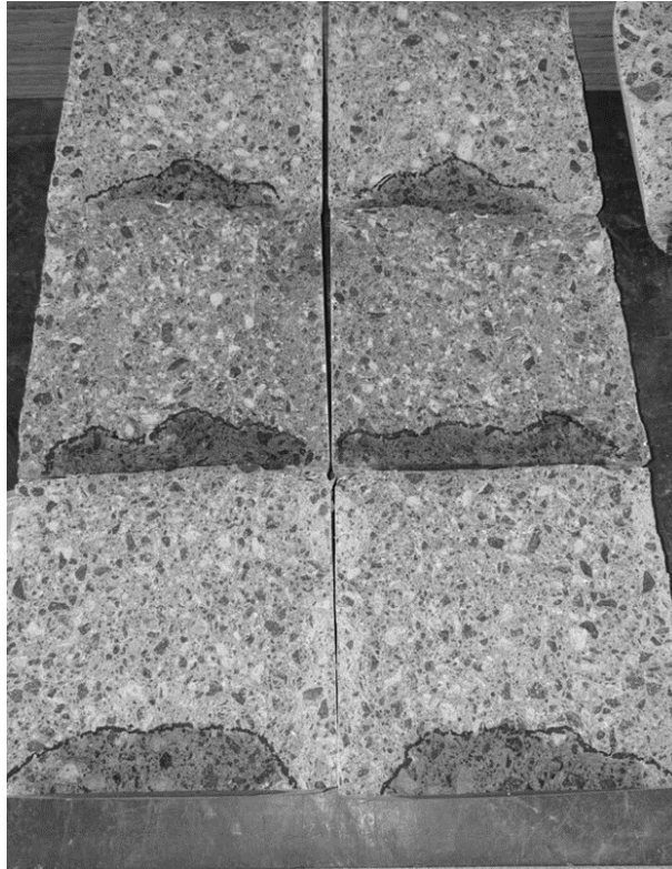
Figura 2. Penetración del agua bajo presión en tres especímenes de concreto, medición de la profundidad máxima de penetración.
