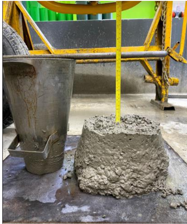
Figura 47. Ensayo asentamiento del concreto en estado fresco.
