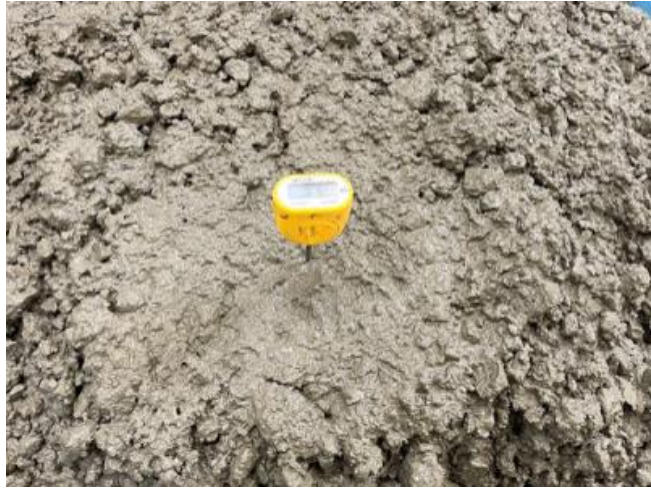
Figura 45. Ensayo temperatura del concreto en estado fresco.
