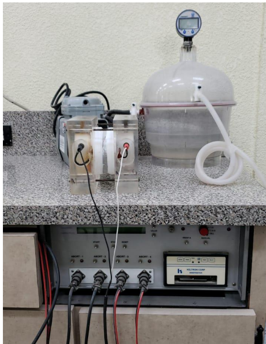
Figura 50. Ensayo permeabilidad del ion cloruro.
