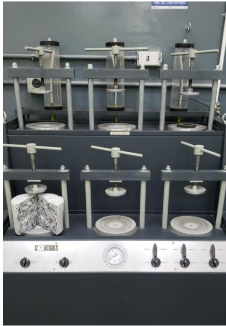
Figura 49. Ensayo profundidad penetración de agua a presión.
