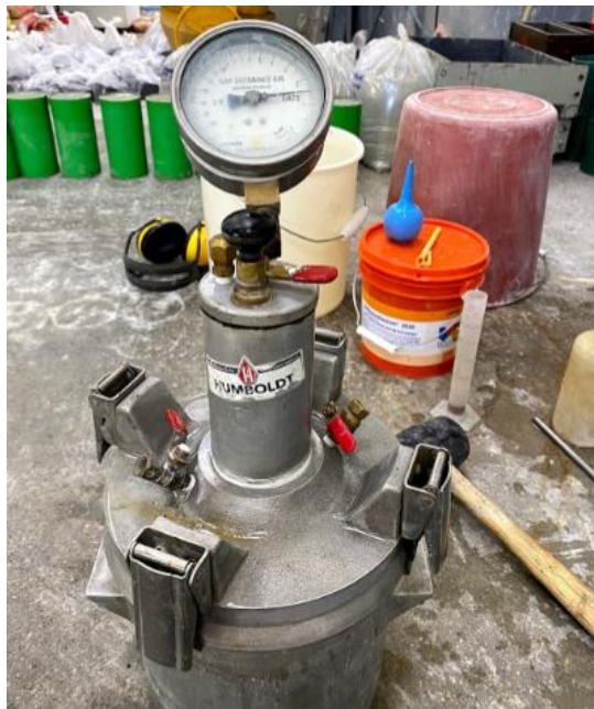
Figura 46. Ensayo contenido de aire de concreto en estado fresco.
