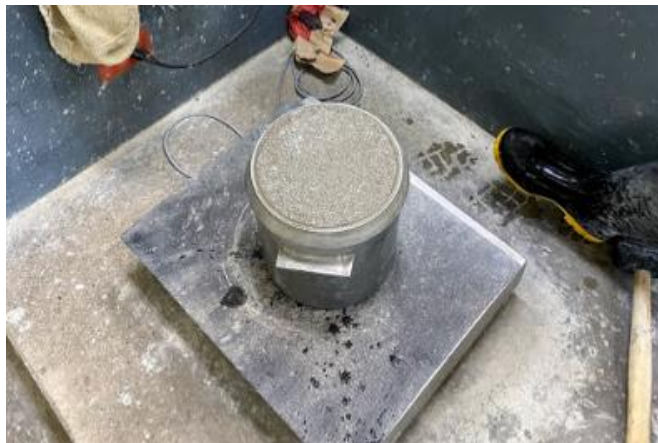
Figura 44. Ensayo peso unitario del concreto en estado fresco.
