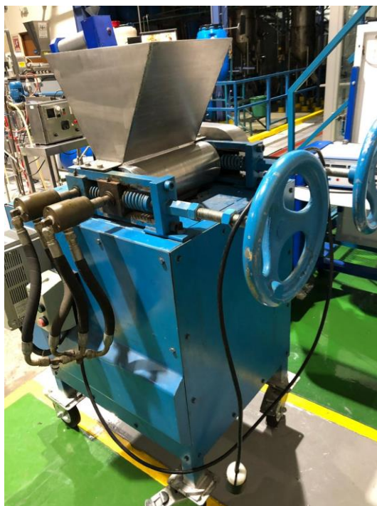
Figura 31. Secador de rodillos del Laboratorio de Operaciones Unitarias de la Universidad del Valle de Guatemala
