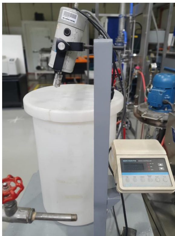
Figura 35. Agitador con motor Servodyne del Laboratorio de Operaciones Unitarias de la Universidad del Valle de Guatemala
