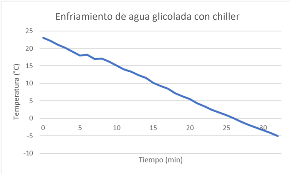
Figura 21. Enfriamiento de agua glicolada con chiller Tempstar
