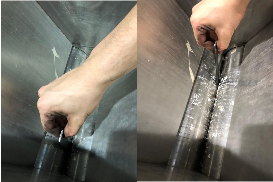
Figura 51. Comparativa de estándar de distancia entre rodillos y grano de malta típico
