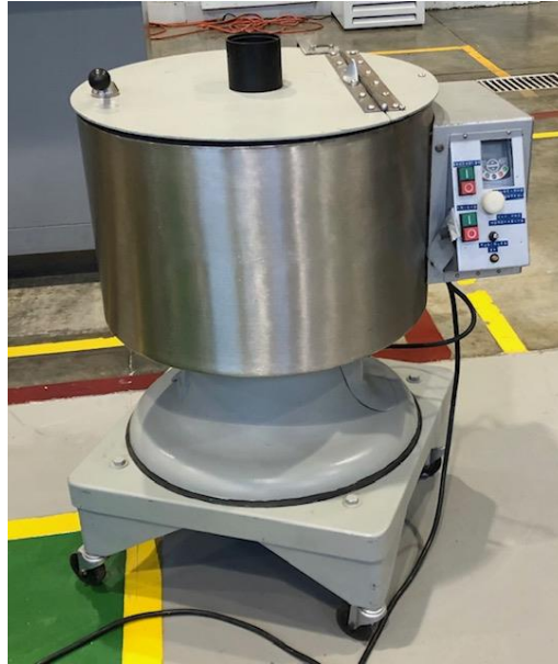
Figura 46. Centrifugadora por lotes del Laboratorio de Operaciones Unitarias de la Universidad del Valle de Guatemala
