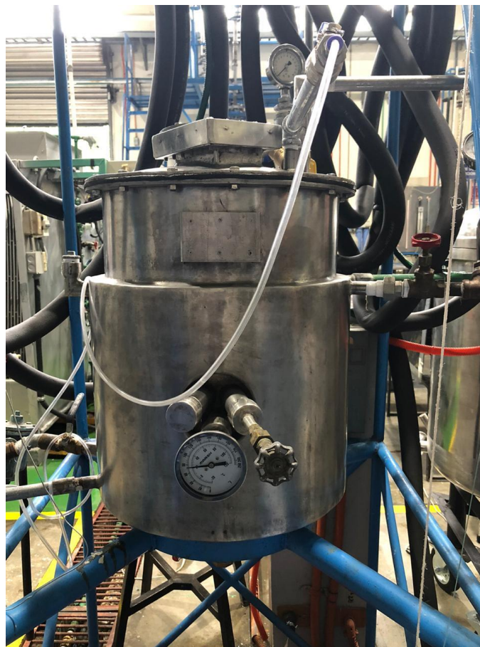
Figura 33. Reactor de la planta piloto de cerveza del Laboratorio de Operaciones Unitarias de la Universidad del Valle de Guatemala
