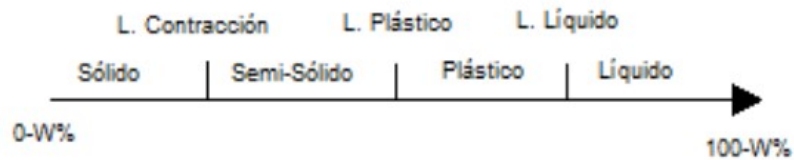
Figura 21: Límites de Atterberg o de consistencia.
