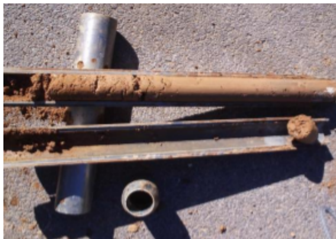
Figura 5: Muestras del suelo extraídas con el SPT.
