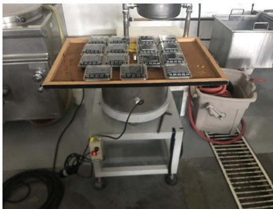
Figura 11. Vibrador hecho para simular el daño mecánico en las moras.
