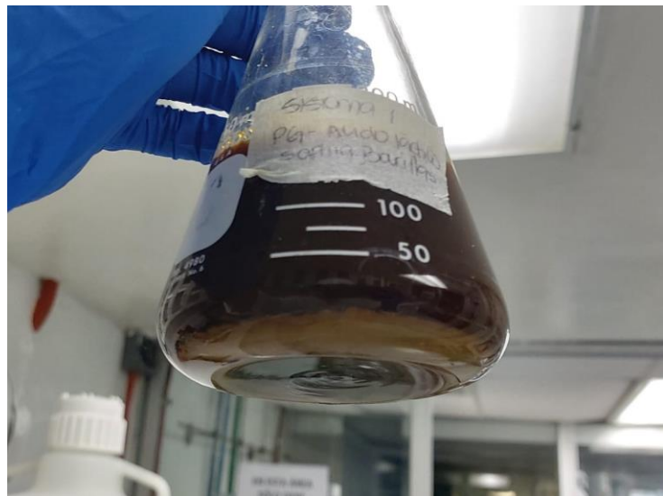
Figura 31. Sistema de fermentación 1 utilizando melaza sin azúcares invertidas, luego de 144 horas de fermentación utilizando Lactobacillus leichmannii
