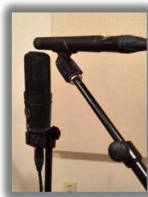
Figura 7: Ejemplo de microfonía Mid-Side
