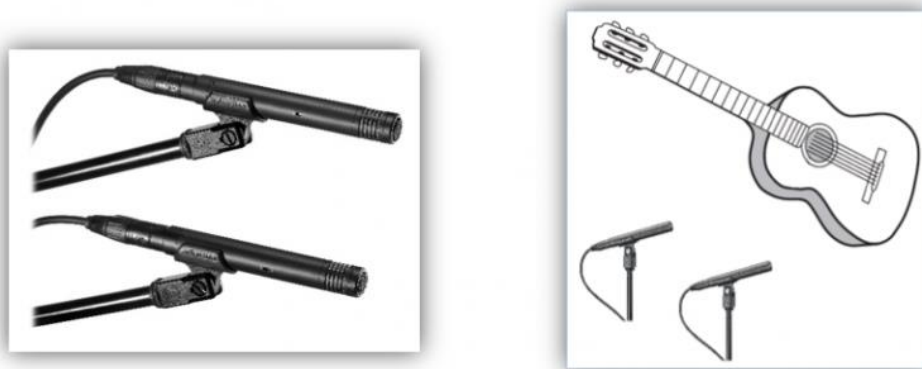
Figura 6: Ejemplos de microfonía A/B
