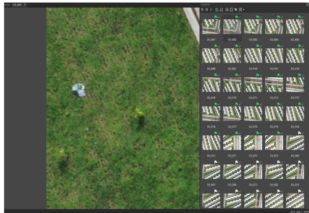
Figura 76: Rectificación de puntos de control Agisoft photoscan
