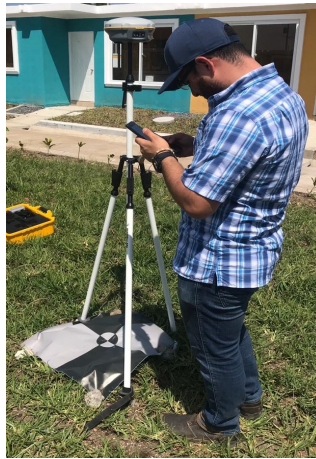
Figura 66: Configuración y toma de puntos de control Trimble DL app
