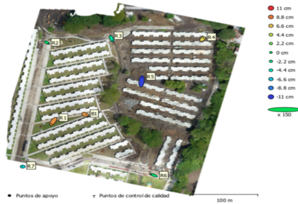
Figura 90: Posiciones de cámaras y estimadores de error
