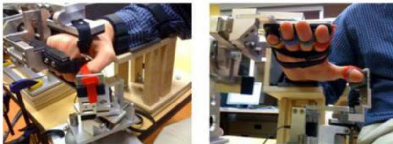
Figura 14. HEXORR, ejemplo de exoesqueleto con movimiento conjunto de los dedos y del pulgar. [22]
