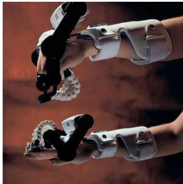
Figura 19. WaveFlex Hand CPM, ejemplo de exoesqueleto con movimiento conjunto de los dedos, sin el pulgar. [27]
