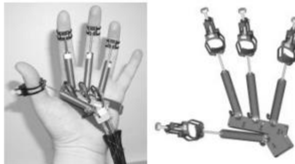
Figura 16. Rutgers Master II, ejemplo de exoesqueleto con movimiento conjunto de los dedos y del pulgar. [24]
