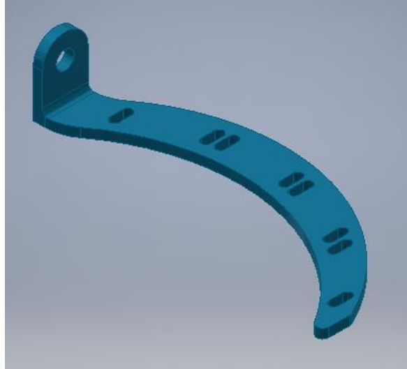
Figura 67. Vista isométrica de la pieza de las falanges medias y distales con ranuras para sujetar cada dedo individualmente.
