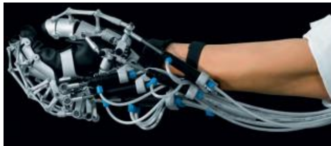
Figura 10. ExoHand, ejemplo de exoesqueleto con movimiento independiente de los dedos y el pulgar. [18]
