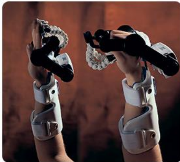
Figura 25. WaveFlex Hand CPM, ejemplo de exoesqueleto con actuador eléctrico. [27]
