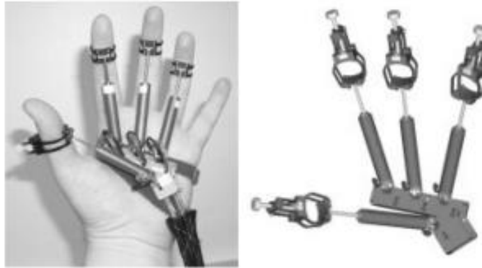
Figura 24. Rutgers Hand Master II, ejemplo de exoesqueleto con pistones neumáticos como actuadores. [24]
