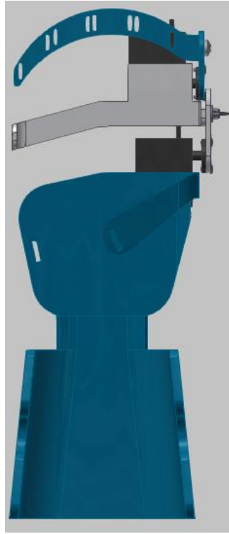
Figura 59. Medición de brazo de fuerza aplicada del centro de las falanges distales hacia el eje del servo.
