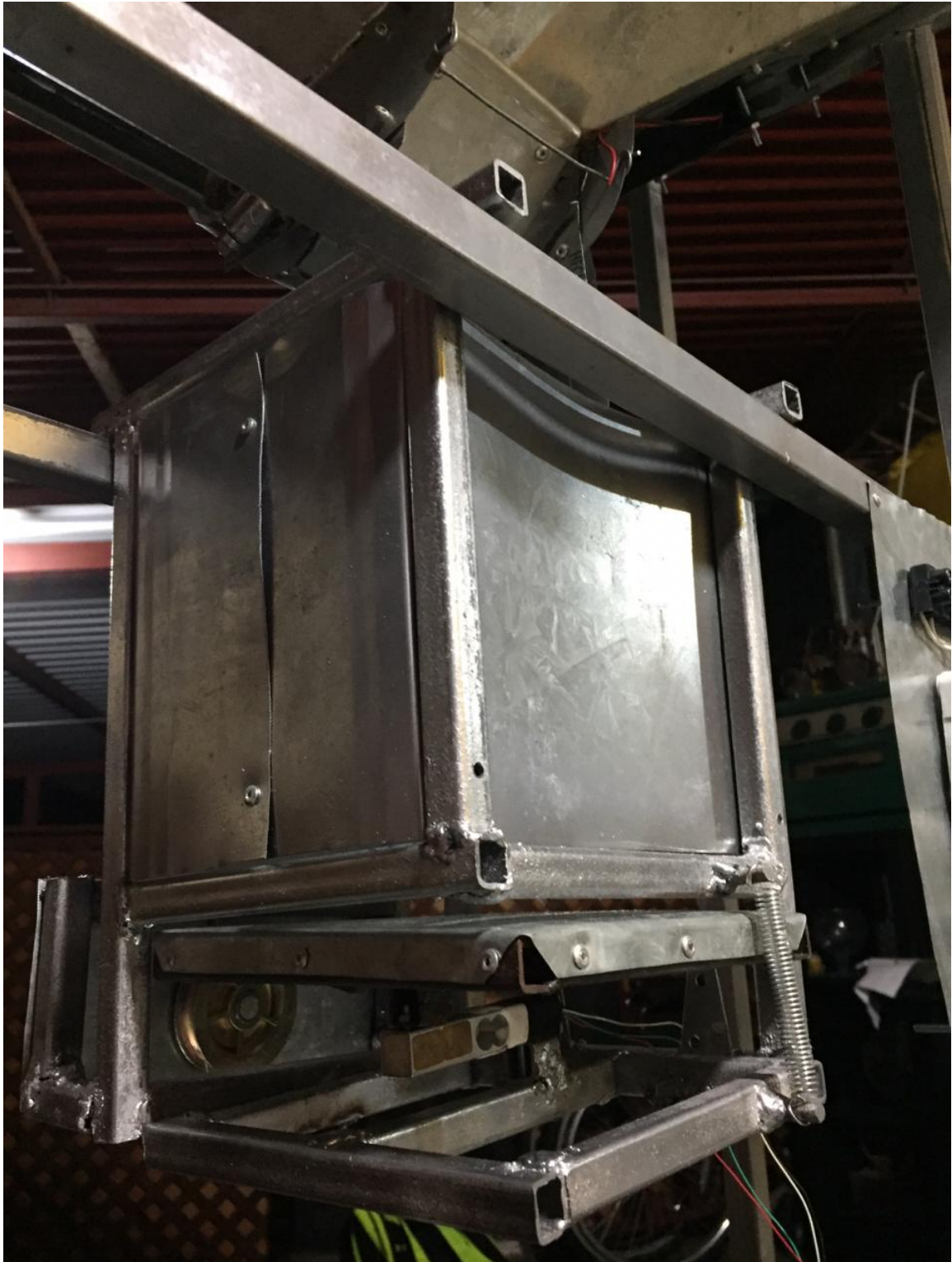
Figura 5.36: Montaje de la báscula con su estructura externa y la plataforma de pesaje real.
