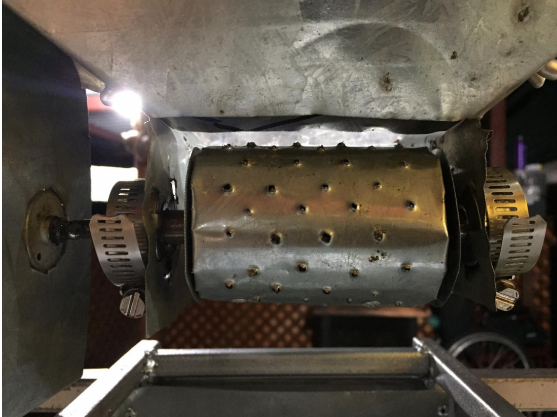
Figura 5.16: Rodillo estriado para mejorar agarre con las papas.
