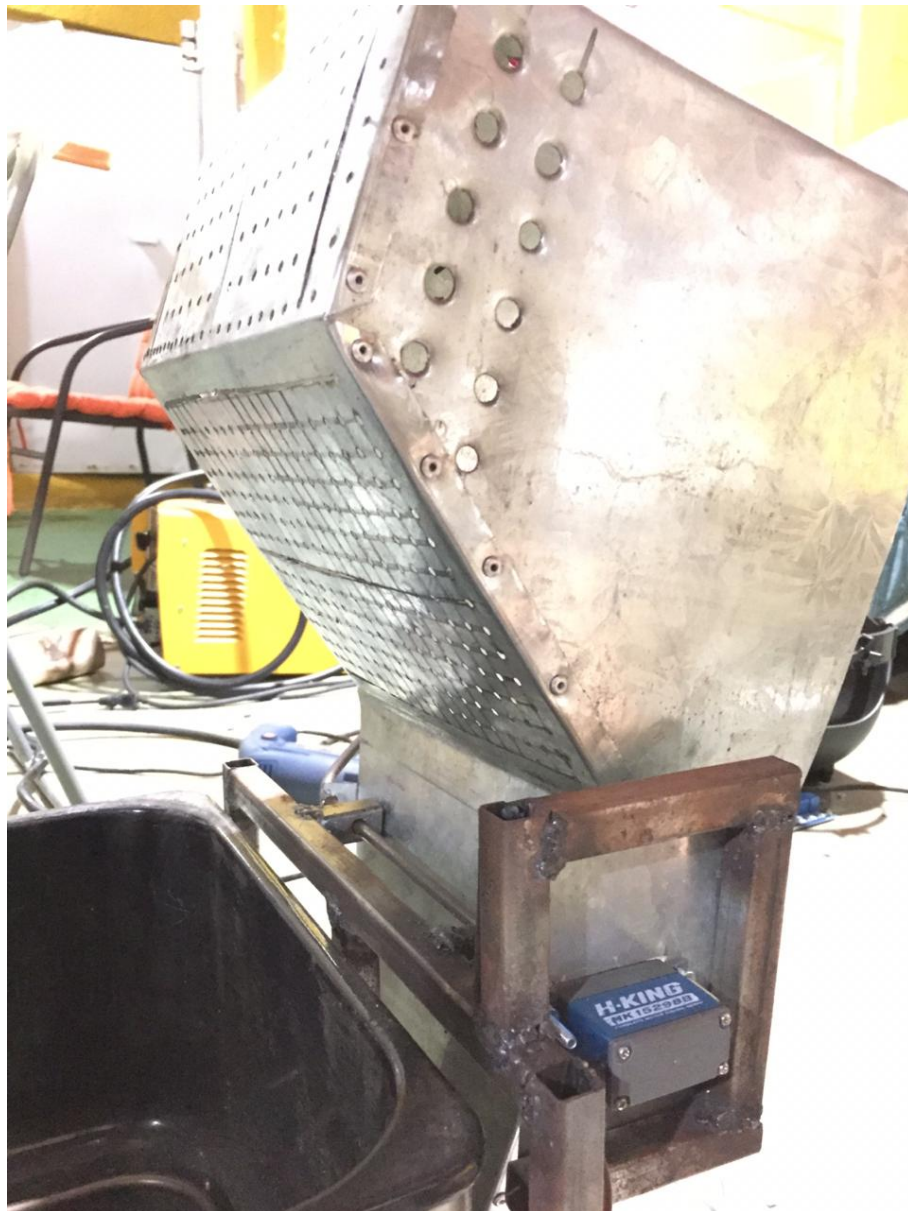
Figura 5.42: Canasta de fritura.
