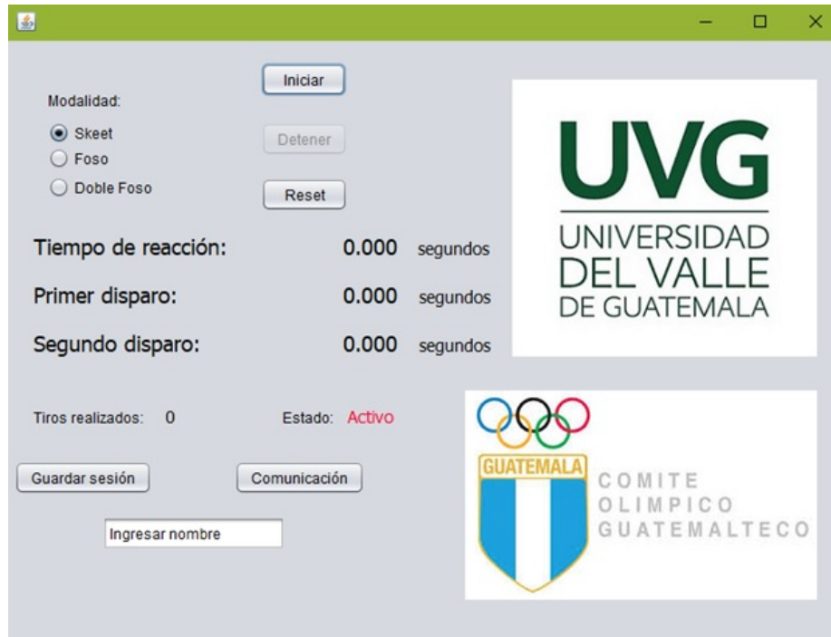
Figura 38: GUI actualizada para prototipo 2
