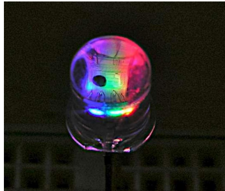
Figura 22: Led RGB de 4 patas con todos los colores encendidos [22]
