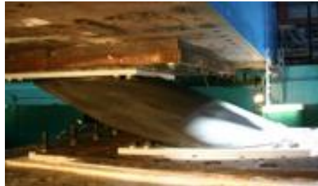
Figura No. 36 Ensayo de un aislador elastomérico
